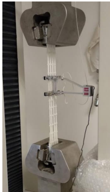
Figura 3. 14. Configuració d'assaig de tracció de malles
