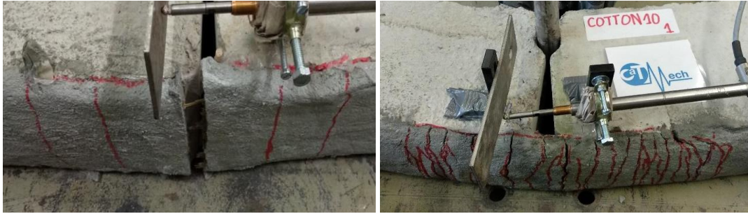
Figura 4. 12. Fissuració dels diferents casos: cànem (esquerra), cotó (dreta)
