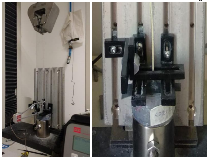
Figura 3. 7. Muntatge de l'assaig a tracció (esquerra), detall de la subjecció de la base (dreta)
