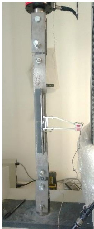
Figura 3. 21. Configuració de l'assaig a tracció de FRCM amb Clevis Grip
