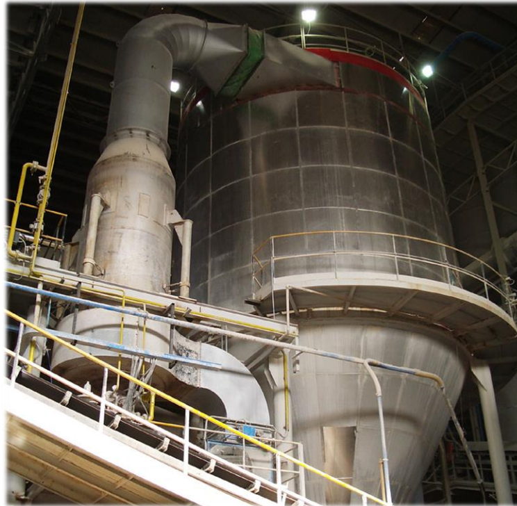
Figura 6. Ejemplo de atomizador industrial utilizado para el secado por atomización. Fuente: IUTC.
