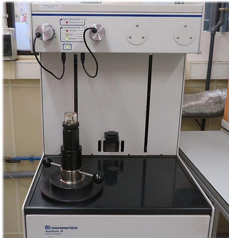
Figura 28. Porosímetro de mercurio, AutoPore IV 9500 de Micromeritics.
