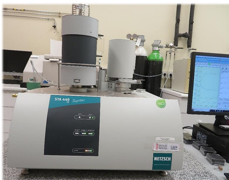
Figura 31. Equipo para el análisis térmico, STA 449 F5 Jupiter de Netzsch.
