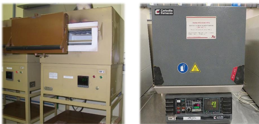
Figura 18. Hornos de laboratorio, horno rápido de Pirometrol a la izquierda y RHF 1400 de Carbolite a la derecha.
