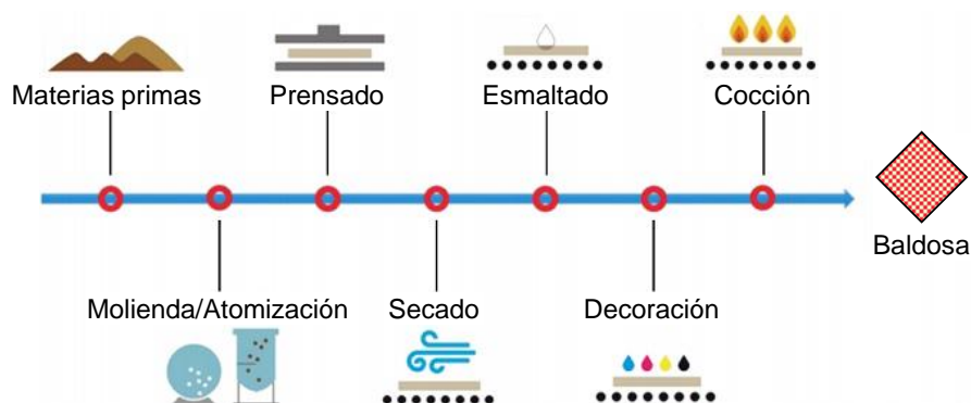
Figura 5. Esquema del proceso de fabricación de baldosas cerámicas por molienda vía húmeda [28].
