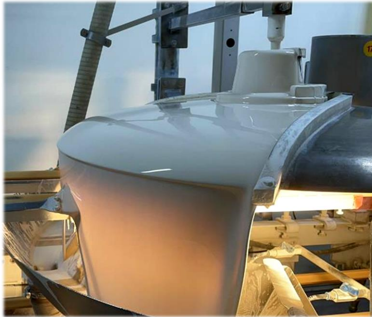
Figura 19. Aplicación de recubrimiento a campana, en forma de cortina continua.
