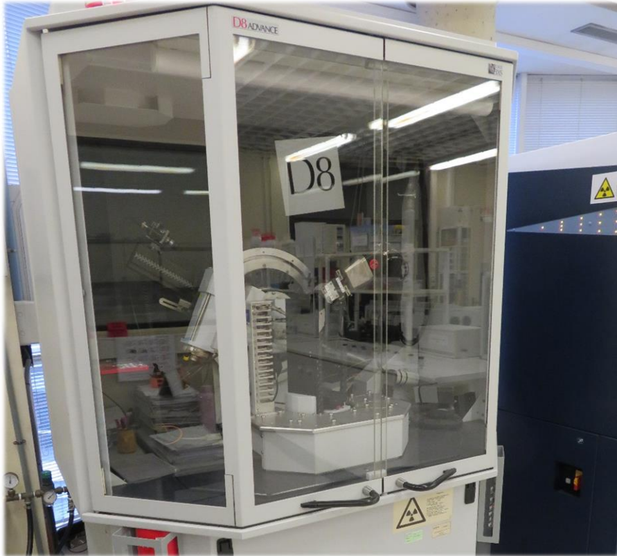
Figura 24. Equipo de difracción de rayos X, D8 Advance de Bruker Theta-theta.
