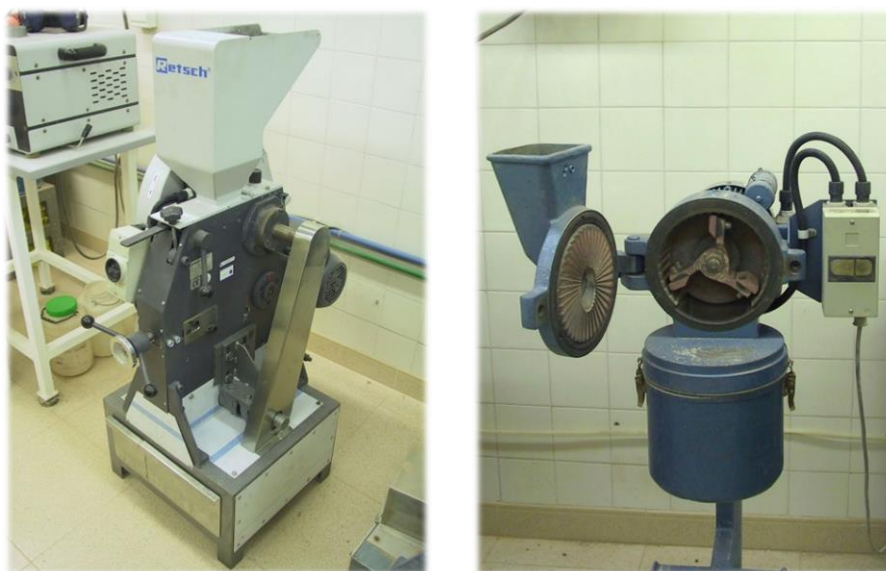
Figura 15. Equipos para la molienda vía seca, triturador de mandíbulas a la izquierda y molino de martillos a la derecha.
