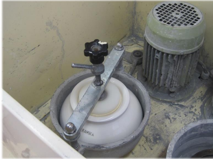
Figura 16. Molino planetario con jarra para la molturación vía húmeda.
