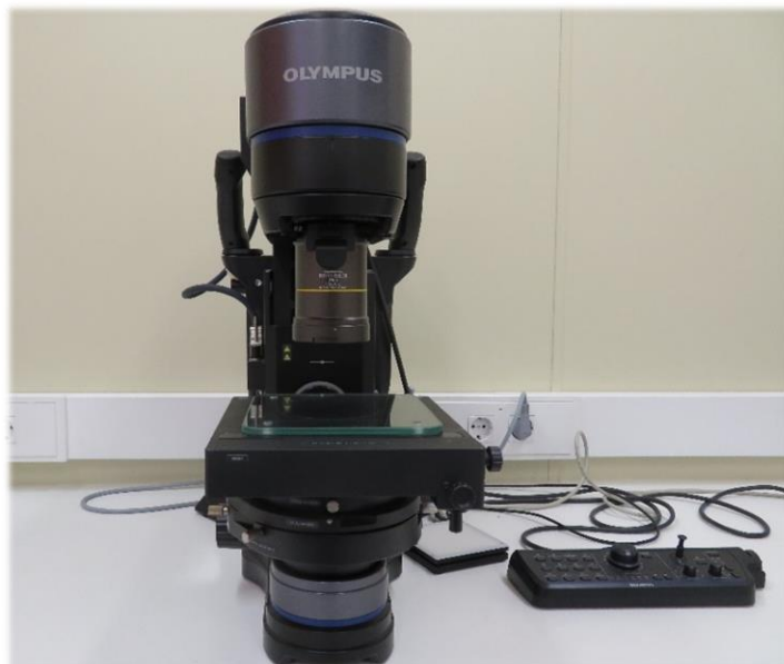
Figura 34. Microscopio óptico digital, DSX1000 de Olympus.
