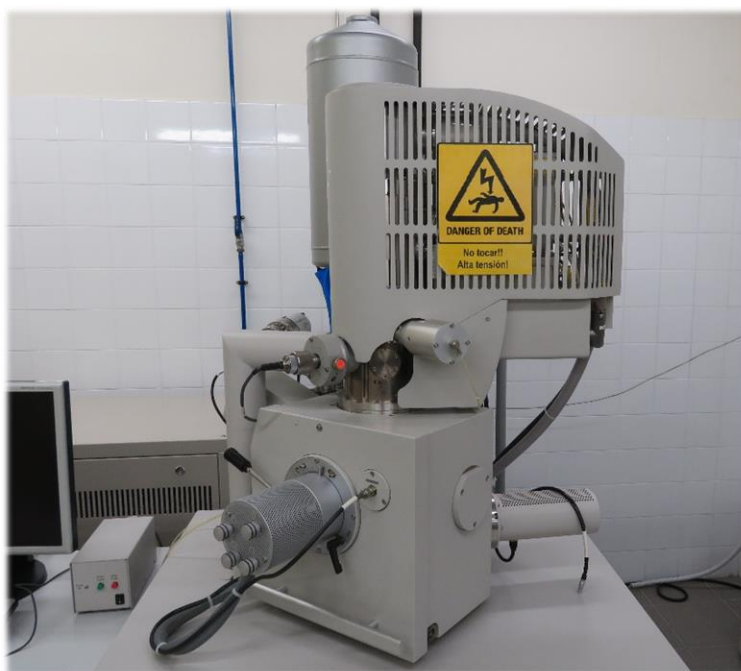
Figura 30. Microscopio electrónico de barrido, FEG-ESEM Quanta 200 de FEI Company.
