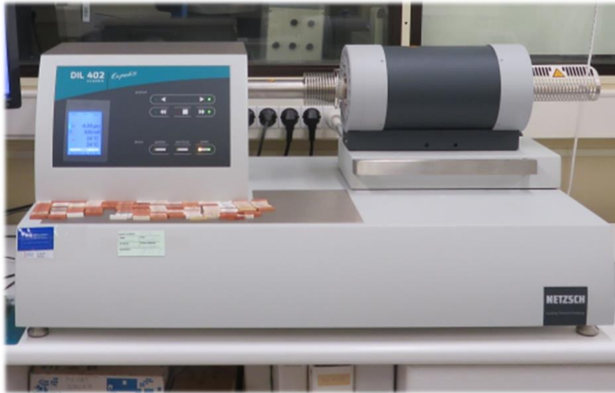
Figura 32. Dilatómetro DIL 402 Expedis Classic de Netzsch.
