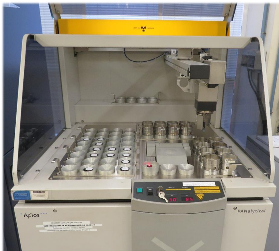
Figura 23. Espectrómetro de fluorescencia de rayos X, Axios de Panalytical.
