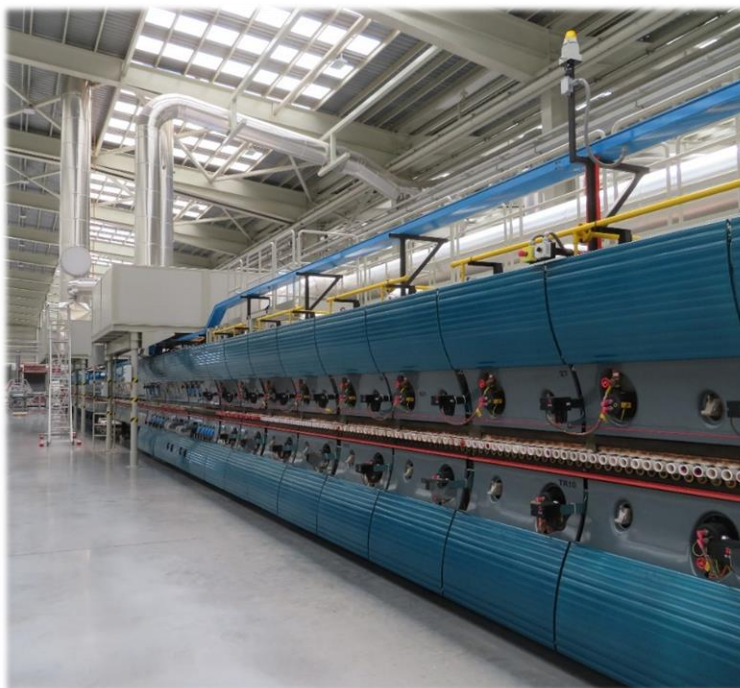
Figura 7. Ejemplo de horno de rodillos industrial para la cocción de baldosas cerámicas. Fuente: IUTC.
