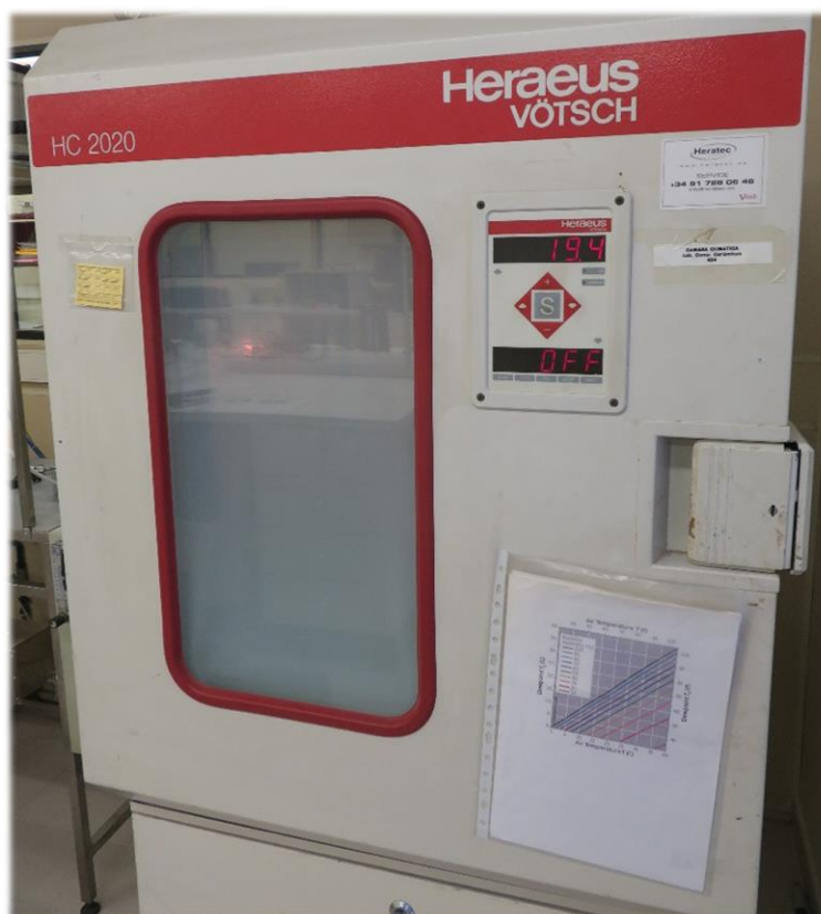
Figura 26. Cámara climática, HC2020 de Heraeus Vötsch.
