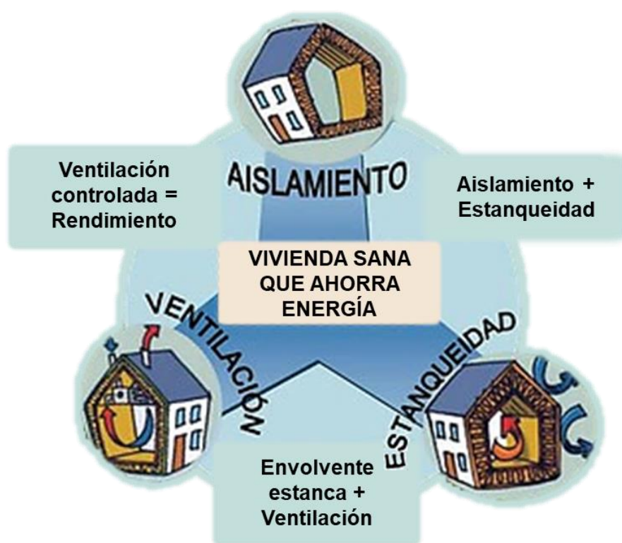
Figura 1. Factores que determinan la salubridad y la eficiencia energética de las viviendas: aislamiento, estanqueidad y ventilación [2].
