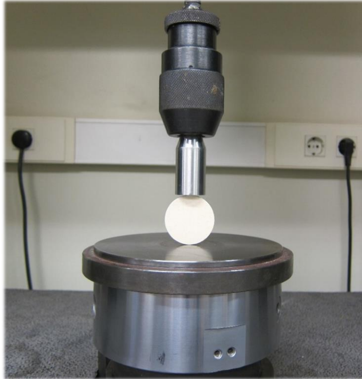
Figura 33. Ensayo de resistencia mecánica por compresión diametral.
