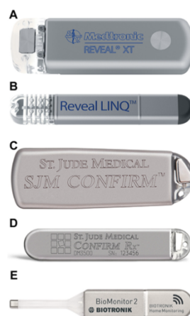
Figura 8: Monitors cardíacs inseribles disponibles actualment.
