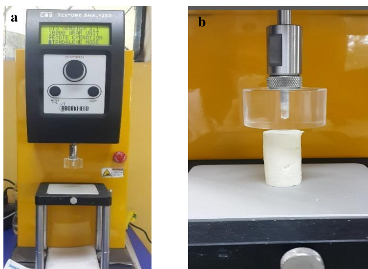
Figura 4.2. Texturómetro Brookfield (a) y sonda TA4/1000 con muestra cilíndrica de queso fresco de 2 cm de diámetro \times 3 cm de altura, utilizados en el ensayo de perfil de textura.
