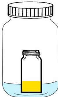
Figura 35. Ilustración del proceso de cristalización por difusión de vapor. El compuesto se encuentra disuelto (solución amarilla) en el vial pequeño, y es insoluble en el disolvente exterior (en azul).
