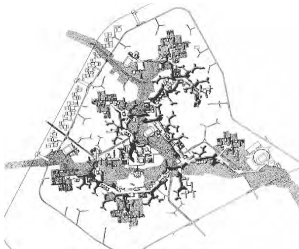
Fig. 2 - Proyecto urbanístico Toulouse le Mirail (Francia) propuesto por Candilis, Josic y Woods, 1962-77. Combinación de clusters y mat-buildings : el barrio tiene una estructura general de cluster y dentro de él, la Universidad de Toulouse le Mirail y el Centro Regional de Reynerie son mat-buildings
