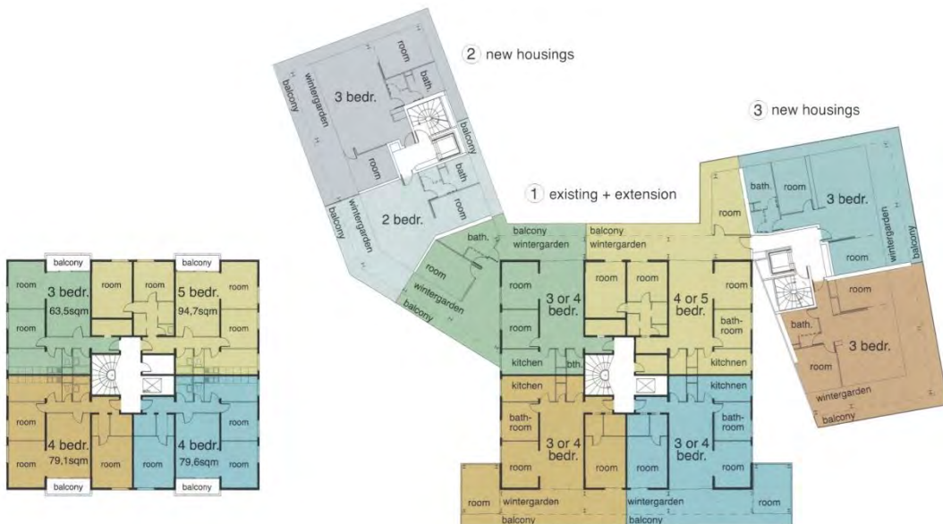
Fig. 51 - Proceso de transformación de la torre de viviendas en Saint Nazaire, 2012-2016. Ampliación de las viviendas con freespace y extensión del espacio habitable de la torre con nuevas viviendas
