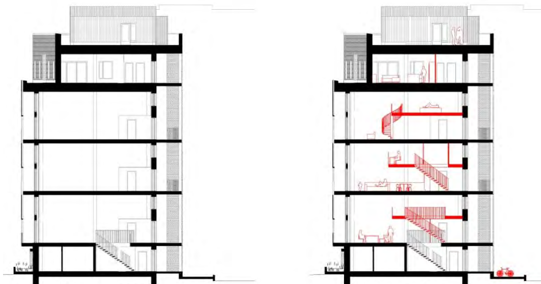
Fig. 83 - Sección transversal A-A de Harkko. Proceso de evolución de los raw spaces triplex, dúplex y simplex entre 2019 y 2020
