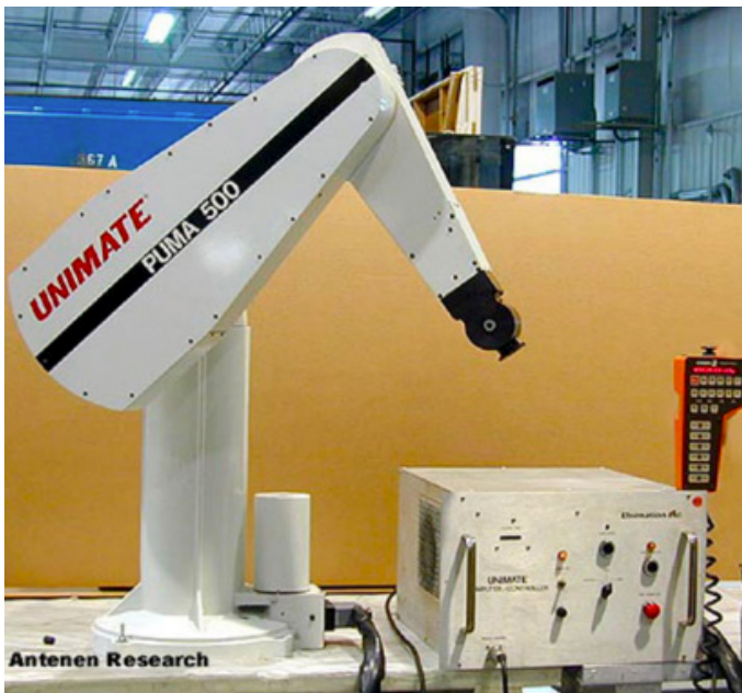
Figura 5. PUMA 500 creado en 1978 por la empresa Unimation Incorporation
