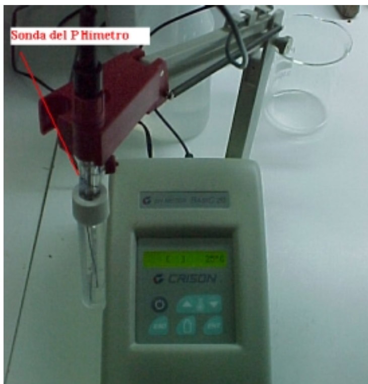
Figura 2.3: PHímetro para analizar la acidez de las muestras
