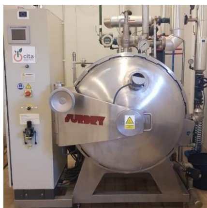
Figura 9. Autoclave convencional de vapor o agua sobrecalentada.
