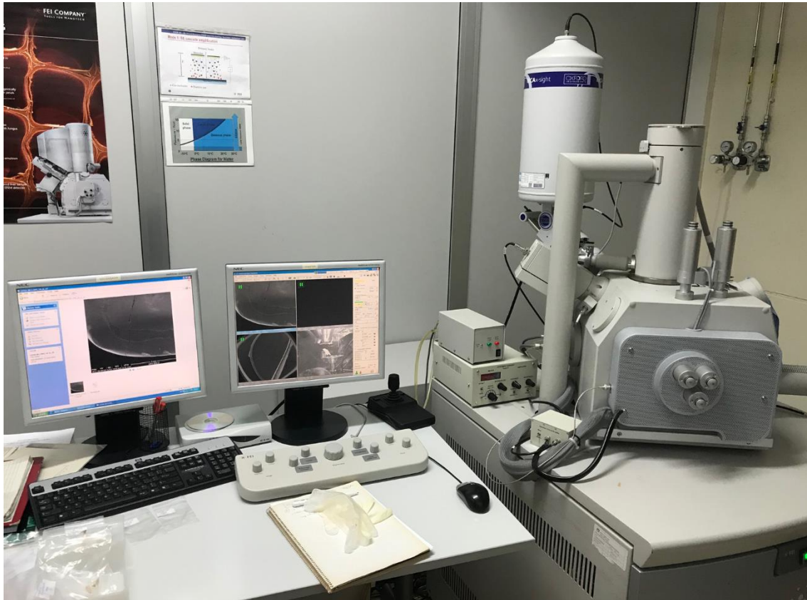
Figura 5.6 Microscopio electrónico de barrido ambiental FEI Quanta 600, ubicado en el Servicio de Recursos Científicos y Técnicos de la Universidad Rovira i Virgili (Tarragona). Créditos: Marina Lozano.
