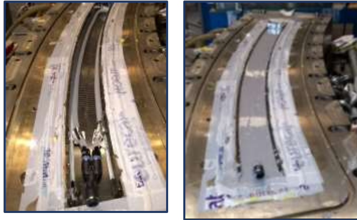
Fig. 5-19: Fabricación del contramolde de la variante SIL55/CA por el proceso de colada.
