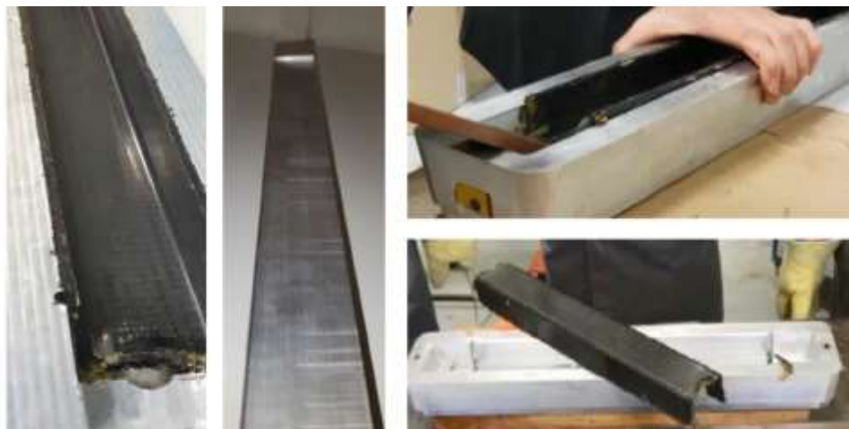
Fig. 6-9: Fase de desmoldeo del perfil en U a temperatura ambiente.
