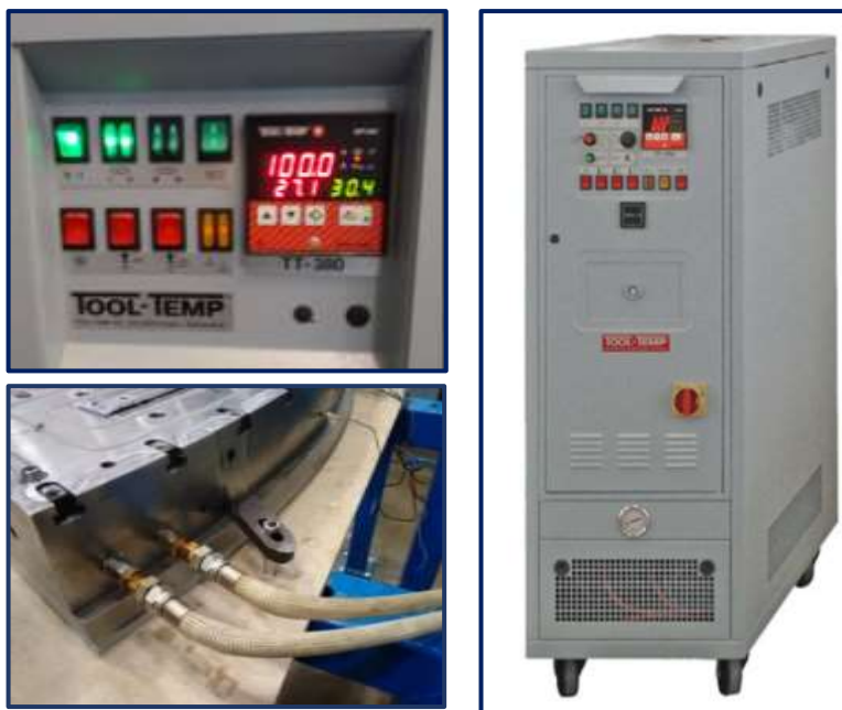
Fig. 3-13: Unidad de control de temperatura de molde.
