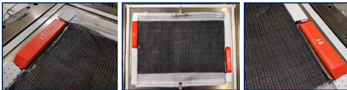
Fig. 4-5: Montaje de los materiales auxiliares para la fabricación de placas planas M02.
