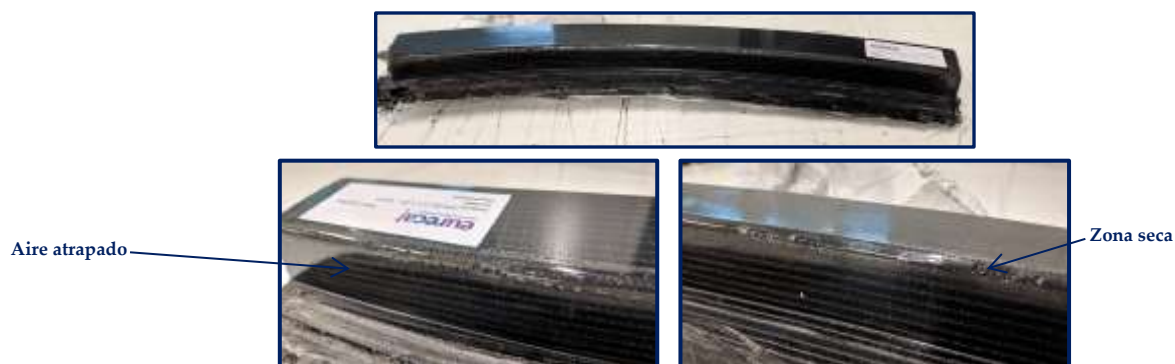
Fig. 1-6: Resultado del primer ensayo de fabricación por la tecnología de infusión por vacío.
