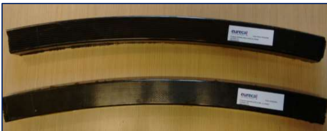
Fig. 6-49: Cuadernas fabricadas por la tecnología RTM.
