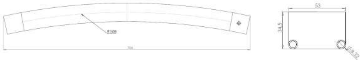
Fig. 5-18: Diseño y dimensiones del conramolde de la variante SIL55/CA (medidas en mm).
