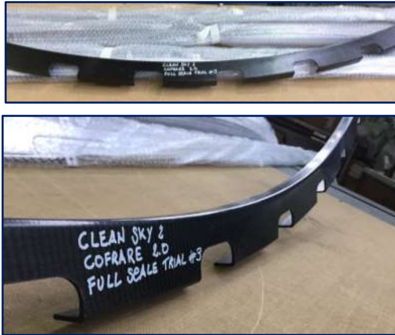
Fig. 6-69: Cuaderna en U fabricada por la tecnología RTM y post-mecanizada.
