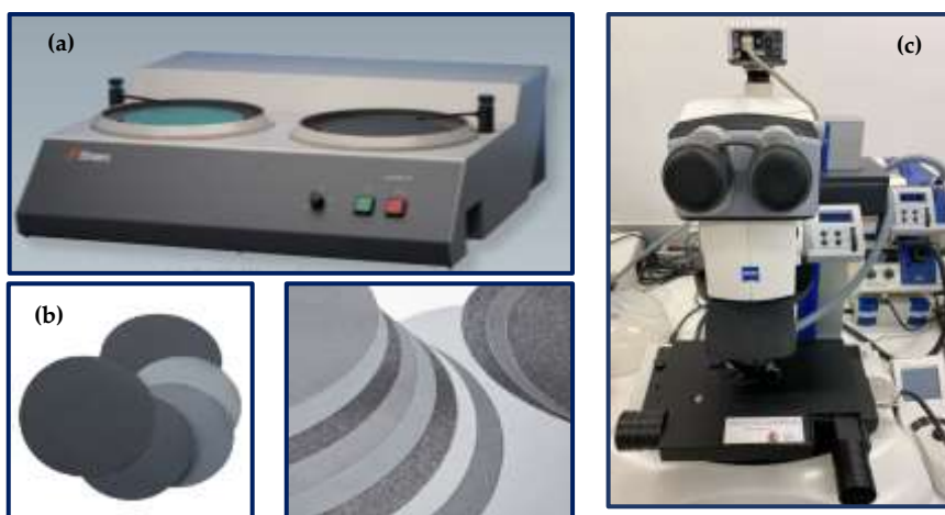
Fig. 3-26: (a) Pulidora manual en húmedo Struers Knuth-Rotor-3 . (b) Discos abrasivos de desgaste (diámetro 250 mm). (c) Microscopio óptico estereoscópico Zeiss Discovery v12 .
