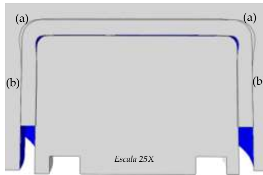
Fig. 6-12: Deformación de forma de la pieza RTM inducida por el postizo cóncavo de acero: (a) deformación en zona curva debida a la diferencia de CTE entre laminado y molde y (b) deformación inducida por el spring-in .
