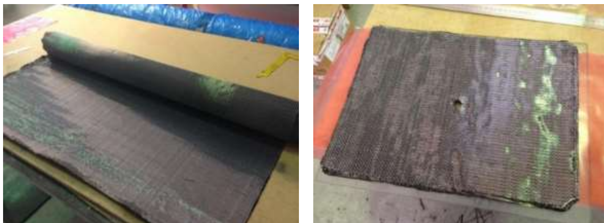
Fig. V-1: Preparación de la preforma para la caracterización del parámetro permeabilidad.
