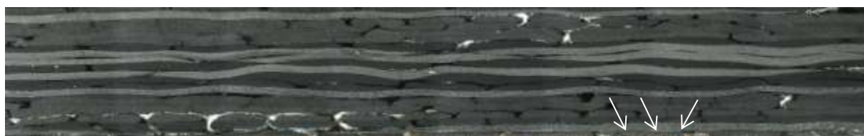
Fig. 6-56: Micrografía óptica de la zona plana de la cuaderna en U fabricada por RTM. Distancia del punto de inyección de 150 mm.
