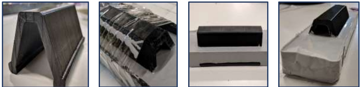
Fig. 5-16: Fabricación por el proceso de colada del contramolde de silicona de la variante SIL55/3D.
