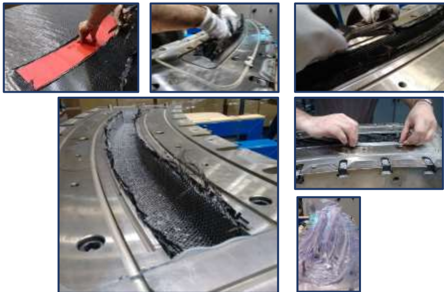
Fig. 5-22: Corte y conformado de las capas y cierre de bolsa de vacío en la fabricación por el proceso de infusión o VI.
