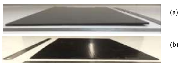
Fig. 1-4: Fabricación de placas de refuerzo NCF de carbono y epoxi, con dimensiones de 380 mm x 260 mm x 2 mm: (a) proceso de infusión por vacío o VI y (b) proceso de moldeo por transferencia de resina o RTM.
