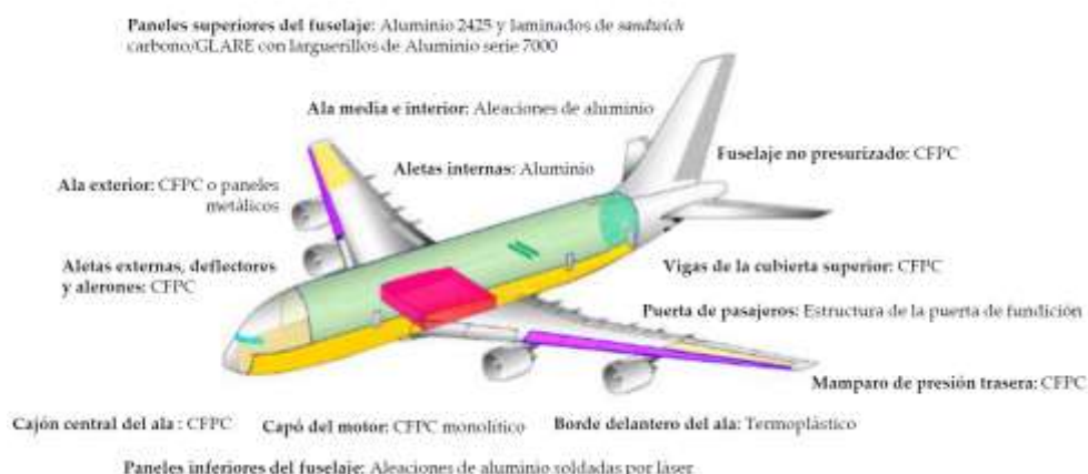
Fig. 2-1: Materiales utilizados en la estructura del Airbus A380. Imagen adaptada [3].
