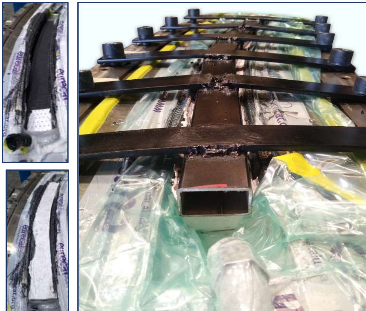
Fig. 5-24: Montaje del contramolde y materiales auxiliares para la infusión con contramolde sólido incompresible (ISCI).
