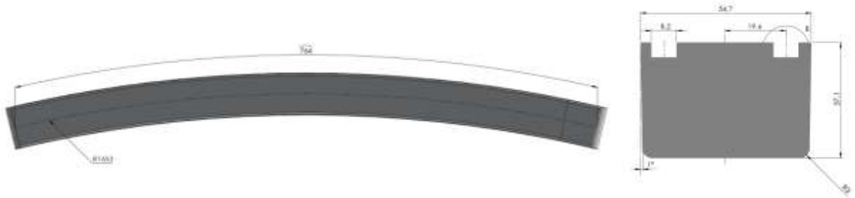
Fig. 6-16: Vista en 2D y dimensiones del postizo convexo fabricado en aluminio 7075T6.
