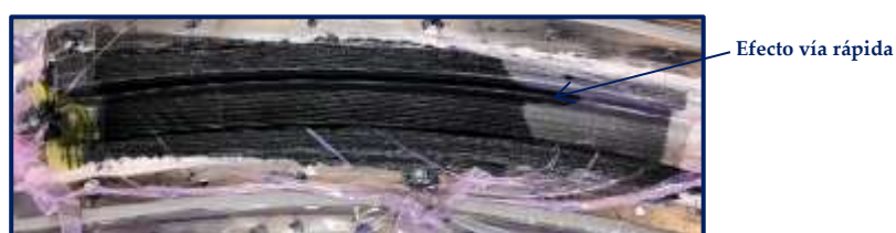
Fig. 1-7: Llenado de la cuaderna en U por el proceso VI y distorsión del frente de flujo debido al efecto de “vía rápida”.
