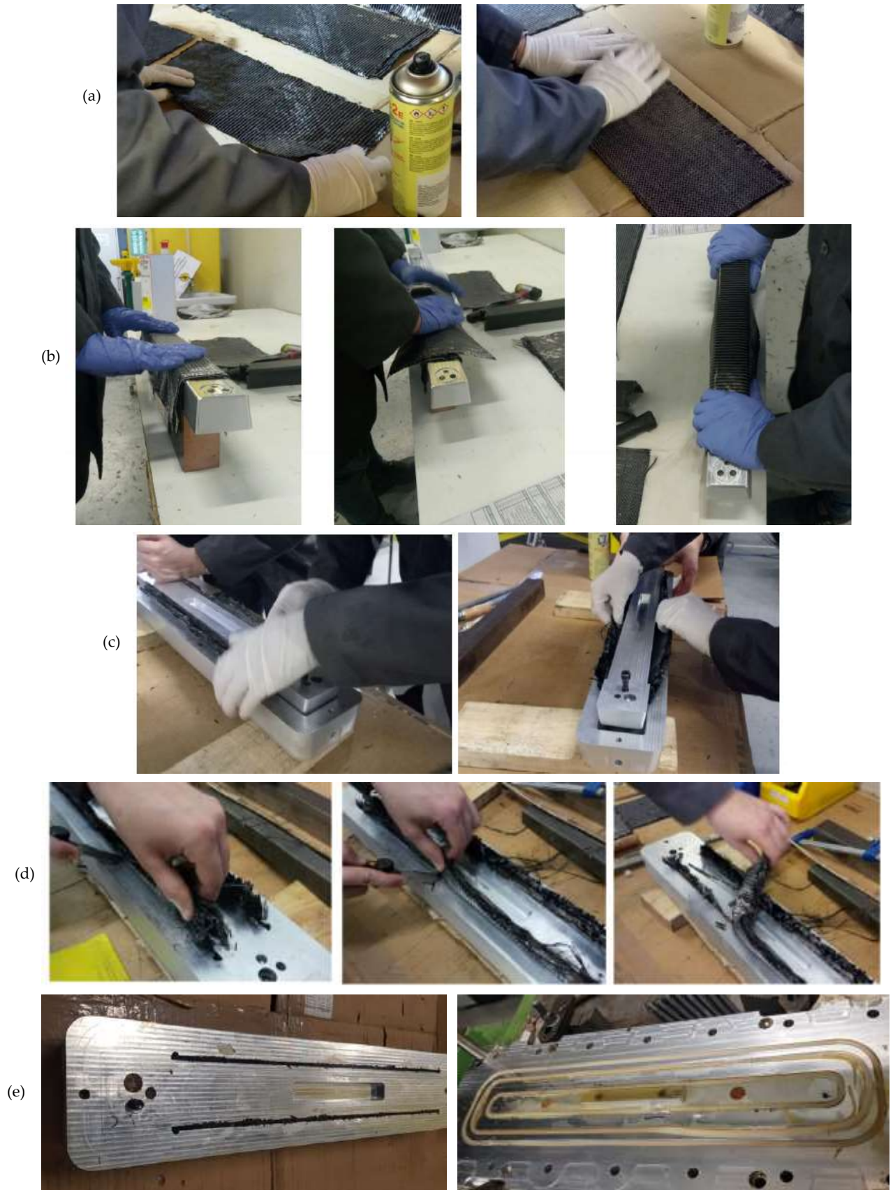
Fig. 6-2: Procedimiento de fabricación del perfil en U por la tecnología RTM: (a) corte y apilado de las capas de tejido no-ondulado, (b) conformado de las capas sobre el contramolde convexo, (c) cierre de molde, (d) corte del remanente de la preforma y (e) molde después de la inyección de resina.
