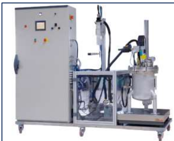
Fig. 3-6: Equipo de inyección Isojet Equipments Modelo RTM & Injection [229]. Propiedad de EURECAT.
