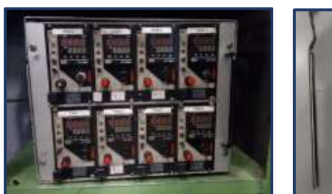
Fig. 3-14: Unidad de lectura de temperatura: (a) Registrador de datos y (b) termopar tipo J.
