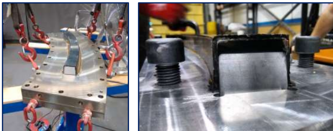
Fig. 6-48: Etapa de desmoldeo en caliente a 180 \pm 5 \text{ }^\circ\text{C} .
