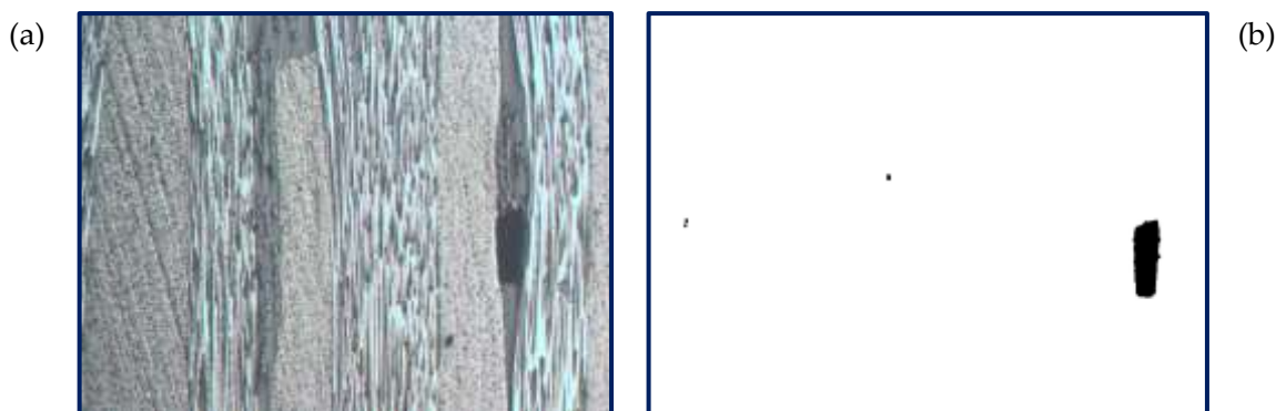
Fig. 3-28: Tratamiento de segmentación de las imágenes de las placas planas: (a) micrografía y (b) imagen binarizada.
