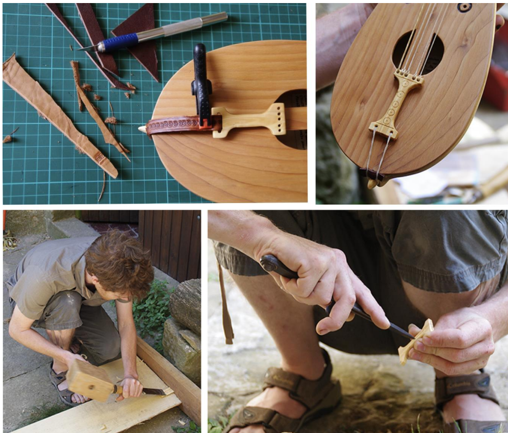
Fig. 431: Restitució de la viula d'Espinelves: cordal original de boix amb fixació de cuir i definitiu, amb cordes de budell; procés d'elaboració del cordal (Olivier Féraud). Fotos LdC.
