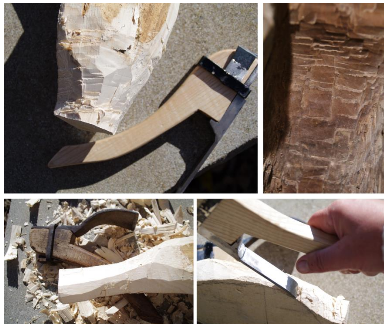
Fig. 445: Restitució de la lira de Pedret: proves de tall amb una aixxa recta i estreta; comparació del tall amb els efectes observats en una talla romànica. Talls llargs i de gran buidat amb l'aixxa vella; talls petits i de major control de la forma amb l'aixola recta. Fotos LdC.
