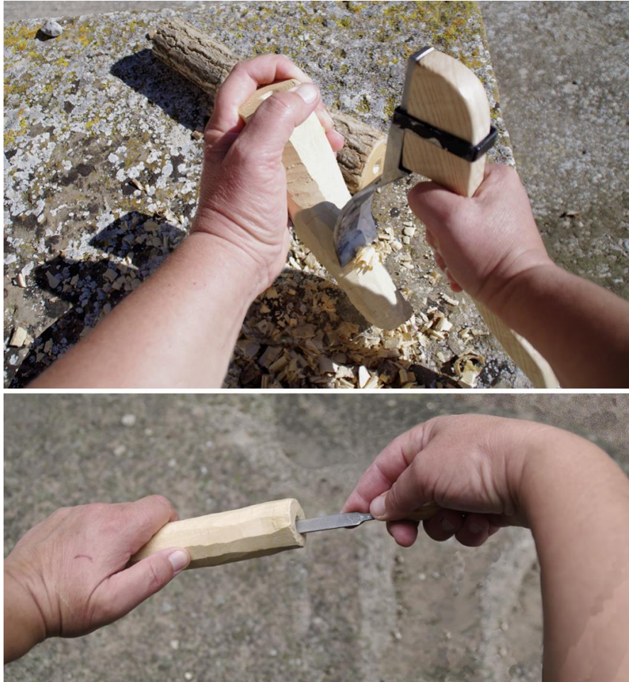
Fig. 413: Treball del sauc per a un aeròfon: extern amb aixà (darrera es pot veure el diàmetre de la medul·la tova); intern, amb una raspa llarga. Foto LdC.
