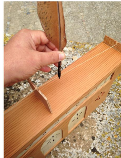
Fig. 592: Monocord: treball a navalla de les tapes i de les obertures interiors; instrument acabat i pinçat amb ploma. Fotos: LdC.
