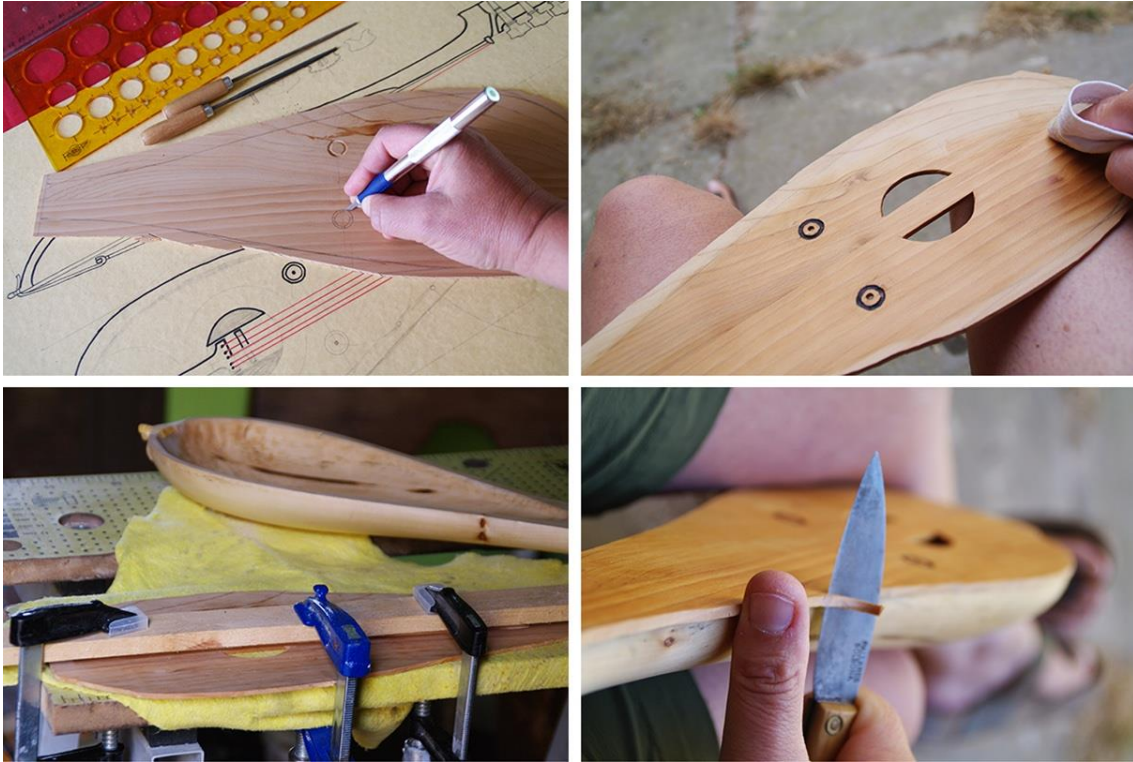
Fig. 430: Restitució de la viula d'Espinelves: tall de les obertures, protecció amb oli de llinosa, reforç amb llistó interior, perfilat. Fotos LdC.
