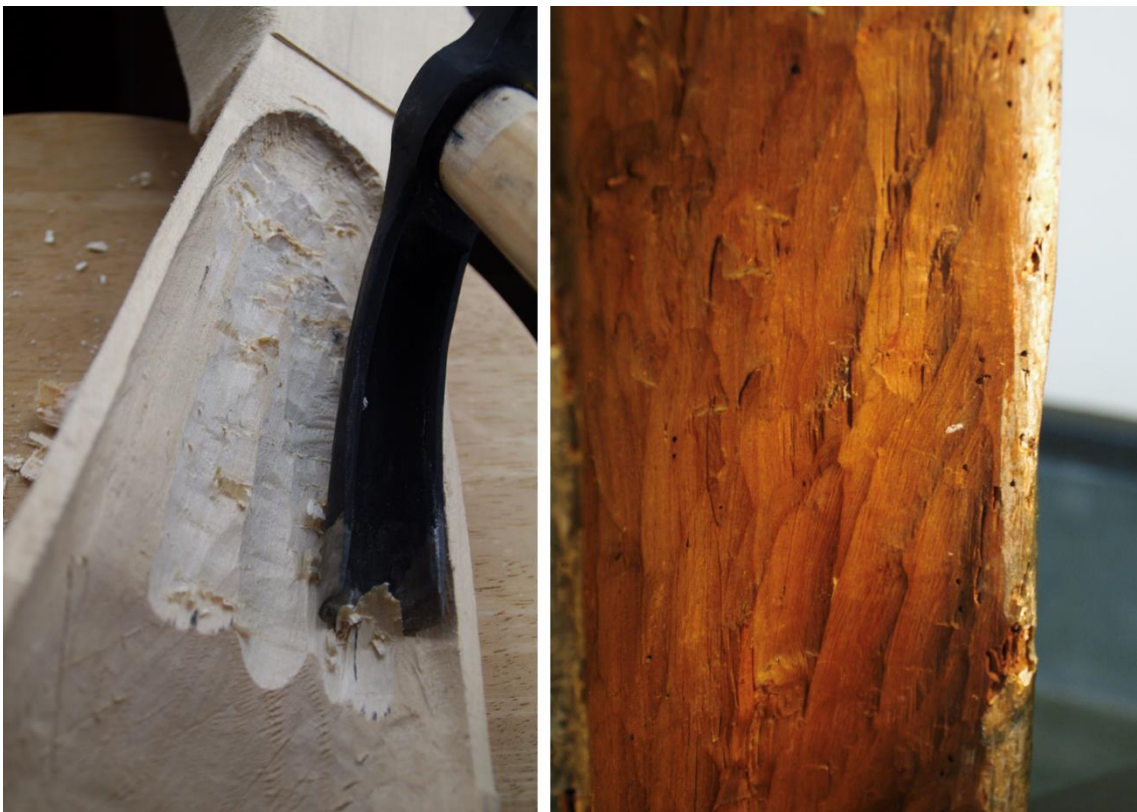
Fig. 447: Restitució de la lira de Pedret: proves de tall tangencial amb una aixa semicircular; comparació del tall amb els efectes observats en una talla romànica. Fotos LdC
