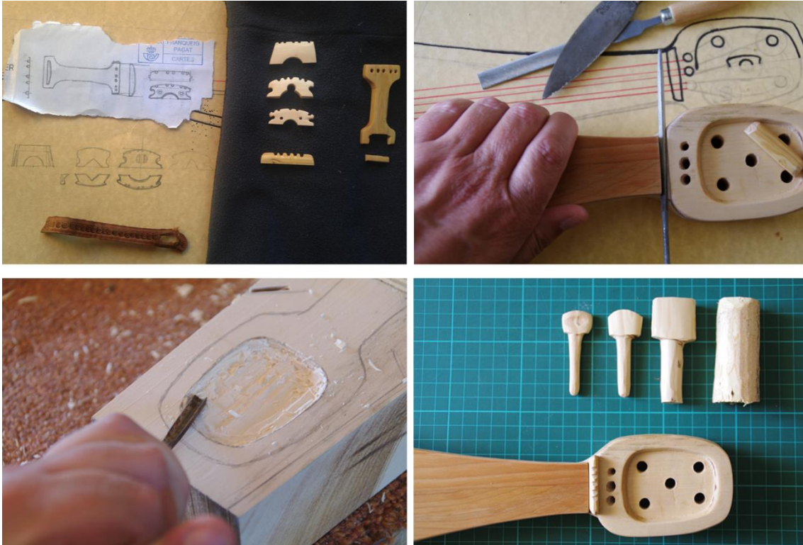
Fig. 432: Restitució de la viüla d'Espinelves: encerts i desencerts de cavallets, fixació de cordal, celleta, claviller i clavilles. Fotos LdC.
