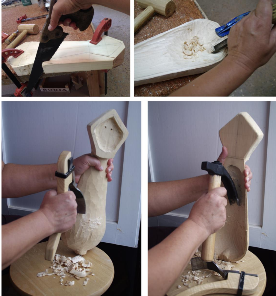
Fig. 436: Restitució de la rabeba de la Seu: treball amb serra de mà, escarpra, gúbia, i en la segona fase de treball amb les dues aixes restituïdes. Foto LdC
