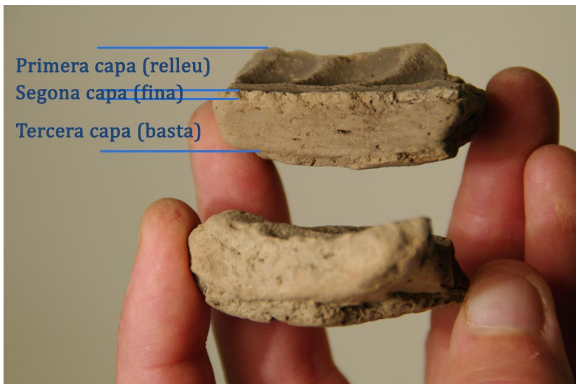
Fig. 174: Negatiu dels motllos de la campana del Mont. Fragments ceràmics amb diferències de pastes. Foto LdC.
