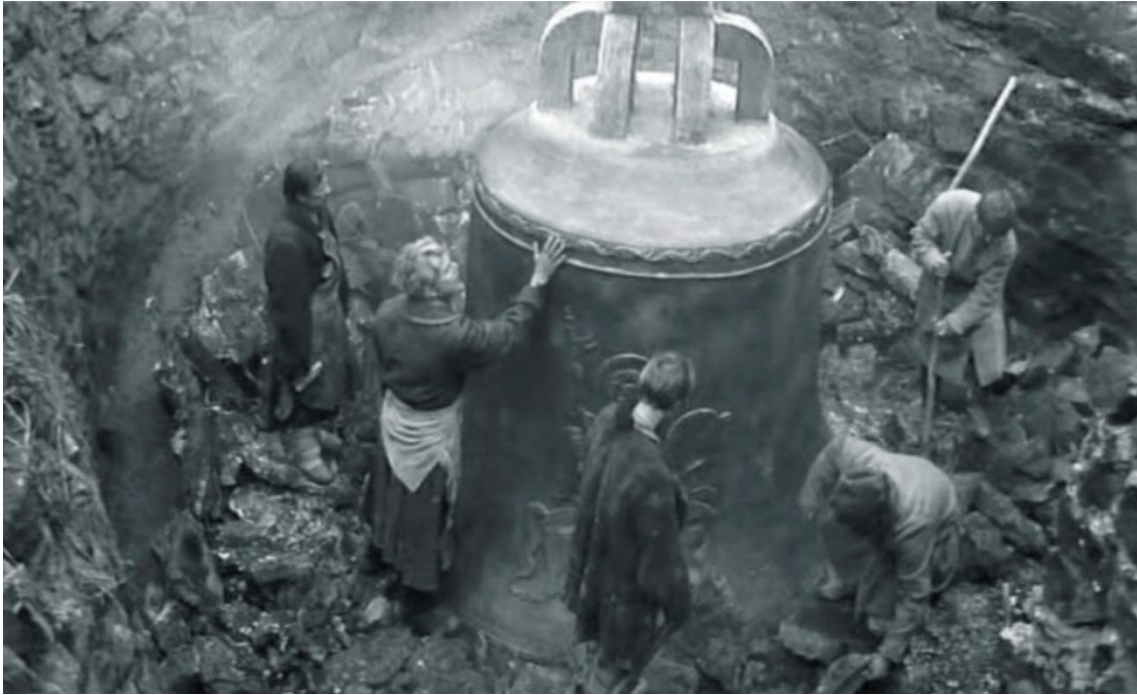
Fig. 157: Polit d'una campana dins del fossat: buidatge del rebliment, verificació dels acabats, polit (fotograma de Andrej Rublev, d'Andrej Tarkowski, 1966).
