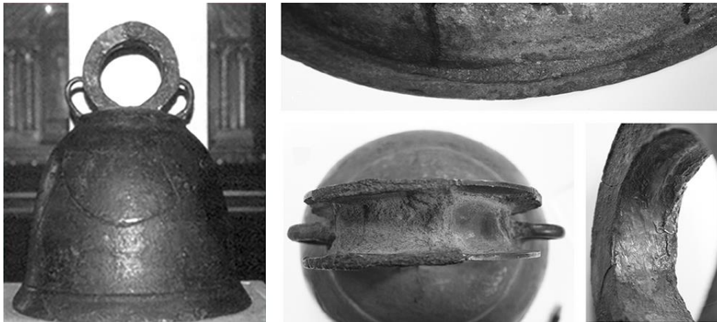
Fig. 115: Campana restituïda de Fleury i detall dels punts de desgast (segles VIII o IX, Abadia de Saint-Benoît-sur-Loire). Fotos: Gonon 2010: 57 i Neri 2012: 487.
