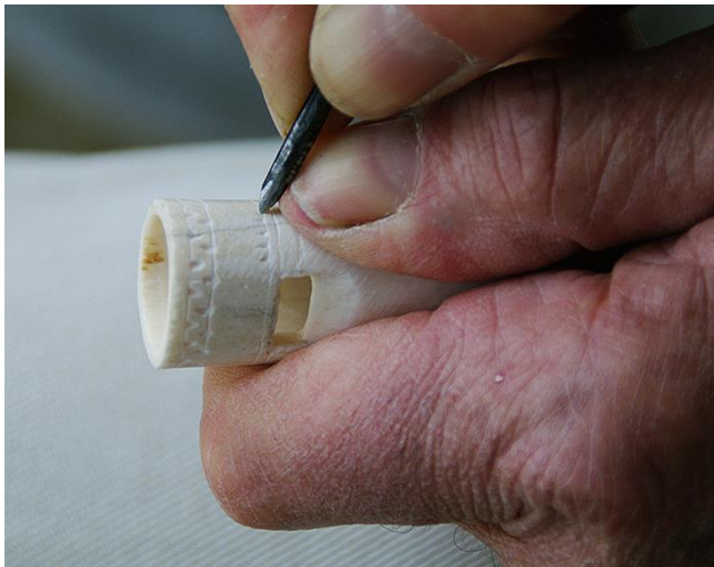
Fig. 25: Embocadura de Rocabruna: treball de l'os amb un burí fet expressament. Faedor Jeff Barbe, foto LdC.
