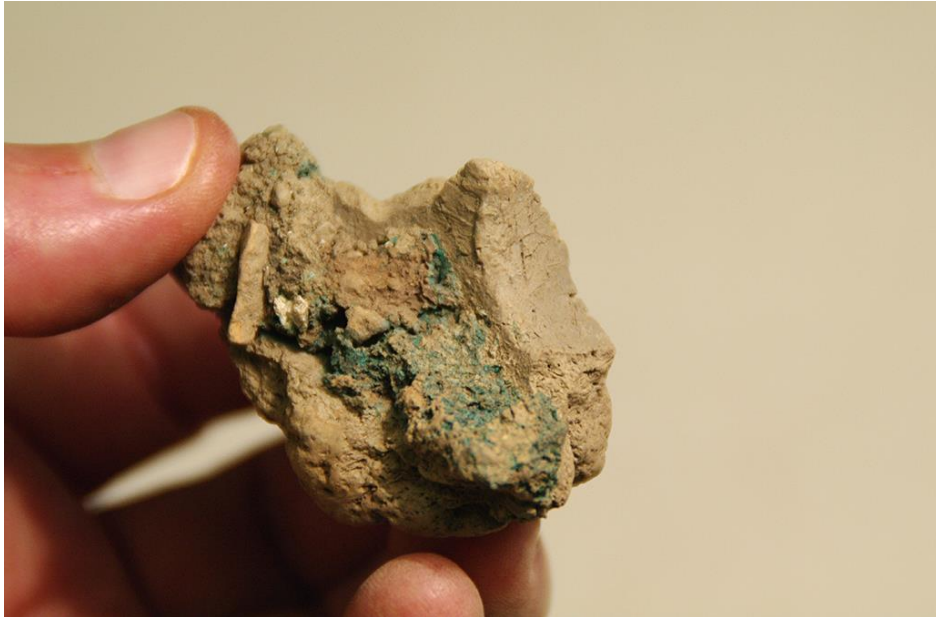
Fig. 173: Negatiu dels motllos de la campana del Mont. Restes d'escòria al canal d'entrada de la colada. Foto LdC.
