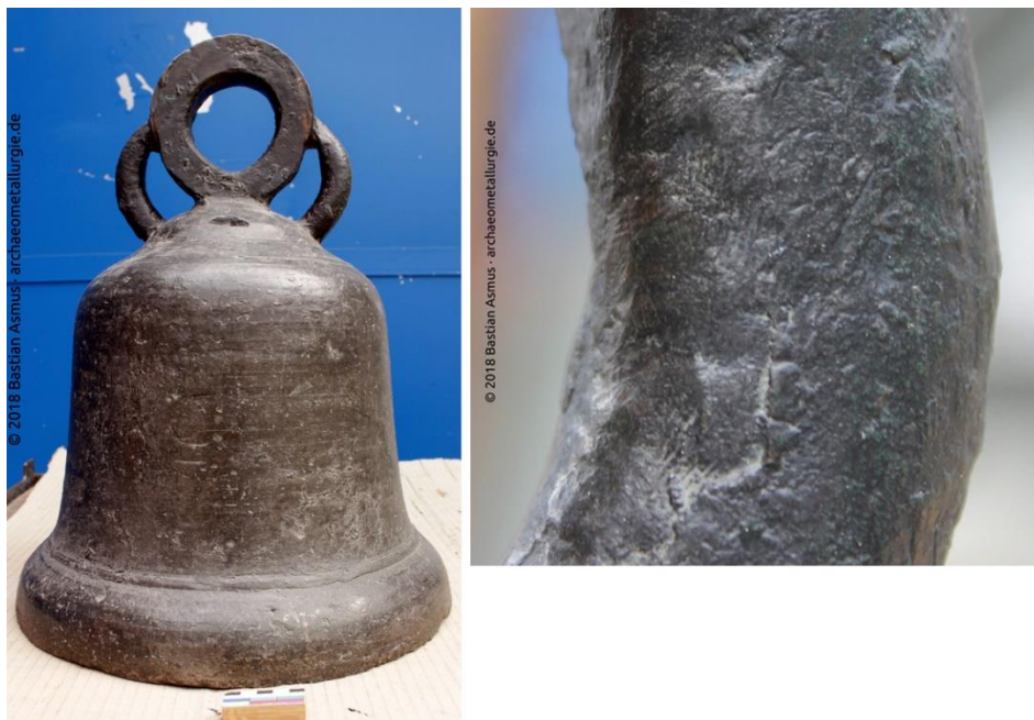
Fig. 164: Campana de Hachen (s. XI, Glockenmuseum Glassmayr, Innsbruck) i detall de les marques dels dits del campaner en el motlle. Fotos: Bastian Asmus, https://en.archaeometallurgie.de [11/2020].
