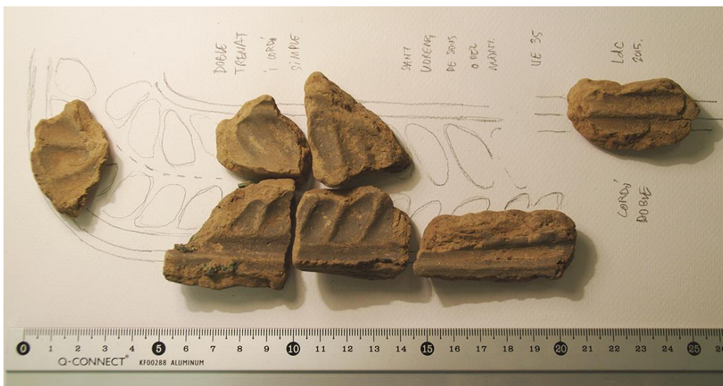
Fig. 172: Negatius dels motllos de la campana del Mont (MAC Pedret, Sant Llorenç de Sous, UE35). Fragments del motllo de les anses trenades, i escòria de bronze. Reconstrucció de les anses, sense presència de creuaments a la corona. Foto LdC.
