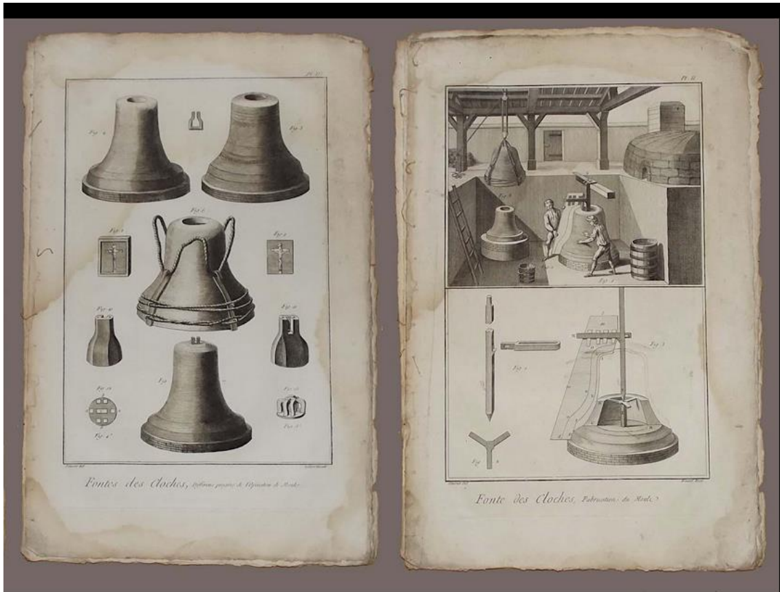
Fig. 147: Elaboració del motlle extern segons l' Encyclopédie : aplicació de la capa exterior amb reforços de cordes i malla de filferros; inclusió de ganxos de ferro fixats amb cordes per a facilitar l'extracció i posterior recol·locació del motlle per mitjà d'un torn ( Encyclopédie , planxes II i III).
