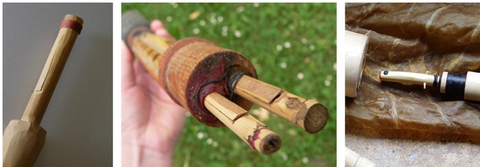
Fig. 229: Llengüeta batent simple de saüc, encaixada per pressió; doble, de canya, fixada amb cera; simple, de canya, fixada amb cordill i amb un bri de palla ben visible (lutiers Jeff Barbe i Denis le Vraux), fotos LdC.
