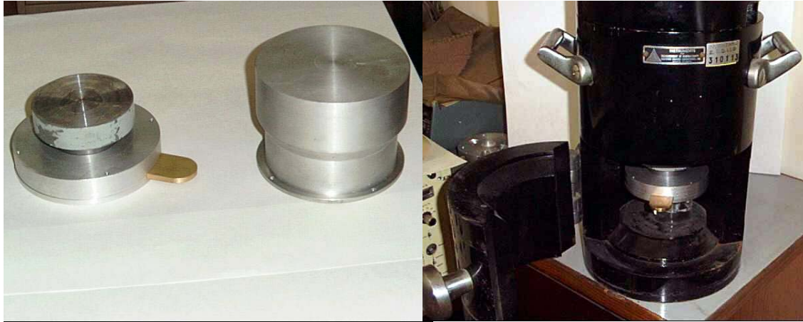
Figura 7.6. Sistema de blindaje de la radiación. a) blindaje de la fuente b) blindaje externo.
