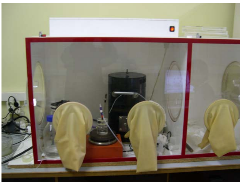
Figura 7.9. Sistema experimental utilizado en los experimentales secuenciales bajo radiación \beta .
