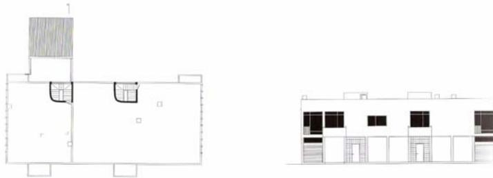
*Planta de cubiertas y alzado principal finales.*
