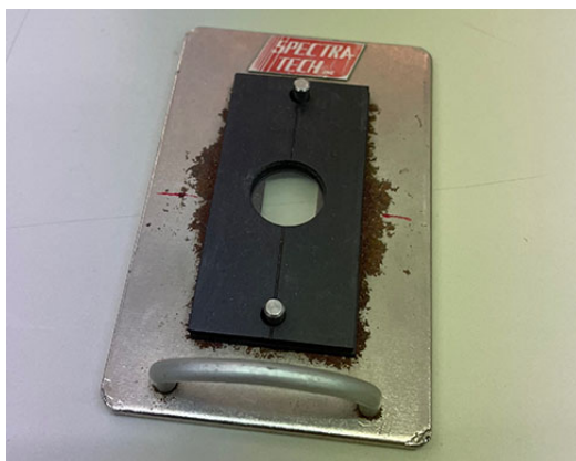
Figura 8.1: Fotografia del portamostres utilitzat en les mesures d'IR, que subjecta una mostra de grafè sobre quars fos (Gr-S2).
