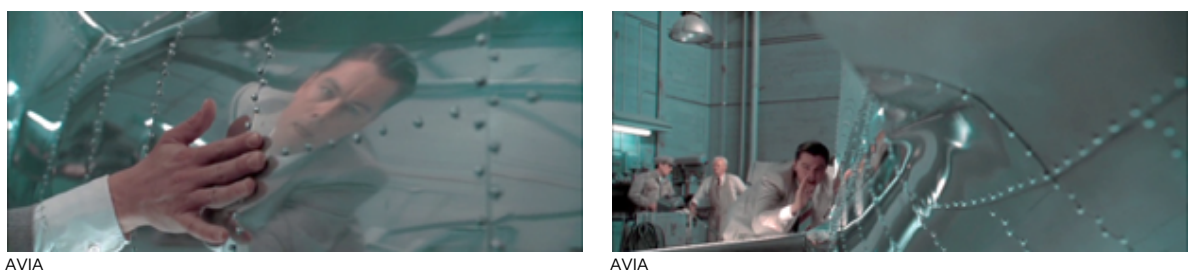
FIG. 51. Howard Hughes reclama remaches completamente enrasados con el fuselaje de uno de sus diseños de avión, siguiendo los principios del streamlining .
