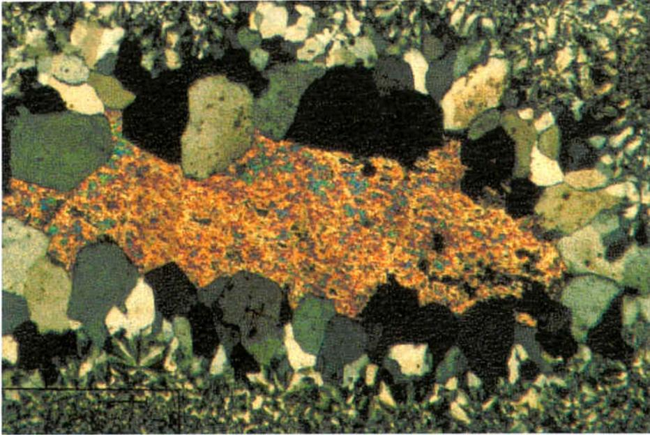
Fig. 74. Megacristales de cuarzo de tipo almenado. MALP 362. NC. 2'5x. En el centro de la imagen observamos carbonato original y porosidad (foto del autor).
