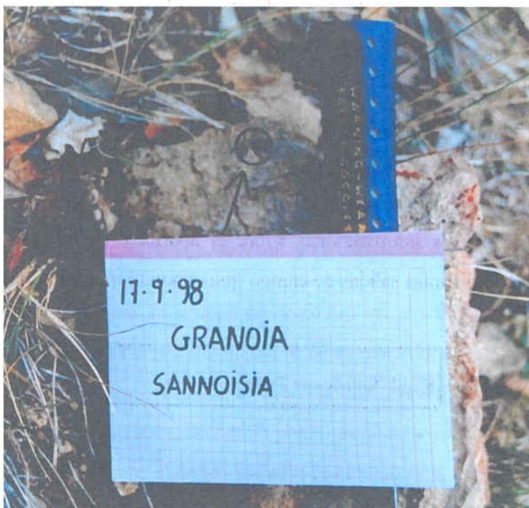
Fig. 120. Enclaves silíceos recuperados en las calizas Sannoisienses de Granoia. El tamaño de las silicificaciones hace inviable su explotación. (Foto del autor)
