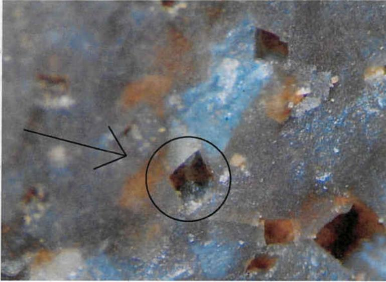
Fig. 137. Pseudomorfo de cristal romboédrico disuelto, observado con la lupa binocular. Tipo “ROG.”
