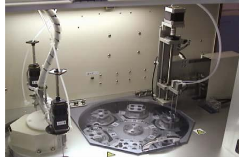
Figura 14: Aparell HANABI PII de processament automàtic de mostres per a l'anàlisi citogenètica.
