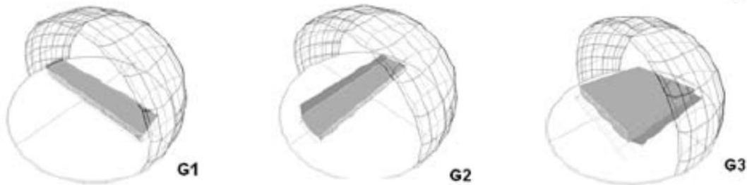
Figura 6: Formas del edificio simuladas para evaluar sus impactos en el consumo energético
