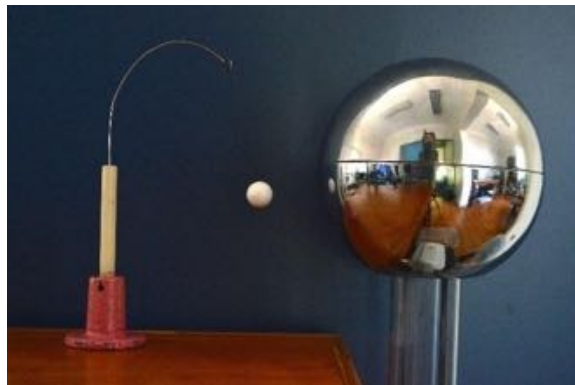
Figura 35 Pelota de plumavit polarizada y atraída por un generador Van de Graaff encendido
