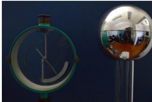
Figura 36 Electroscopio inducido por un generador Van de Graaff encendido
