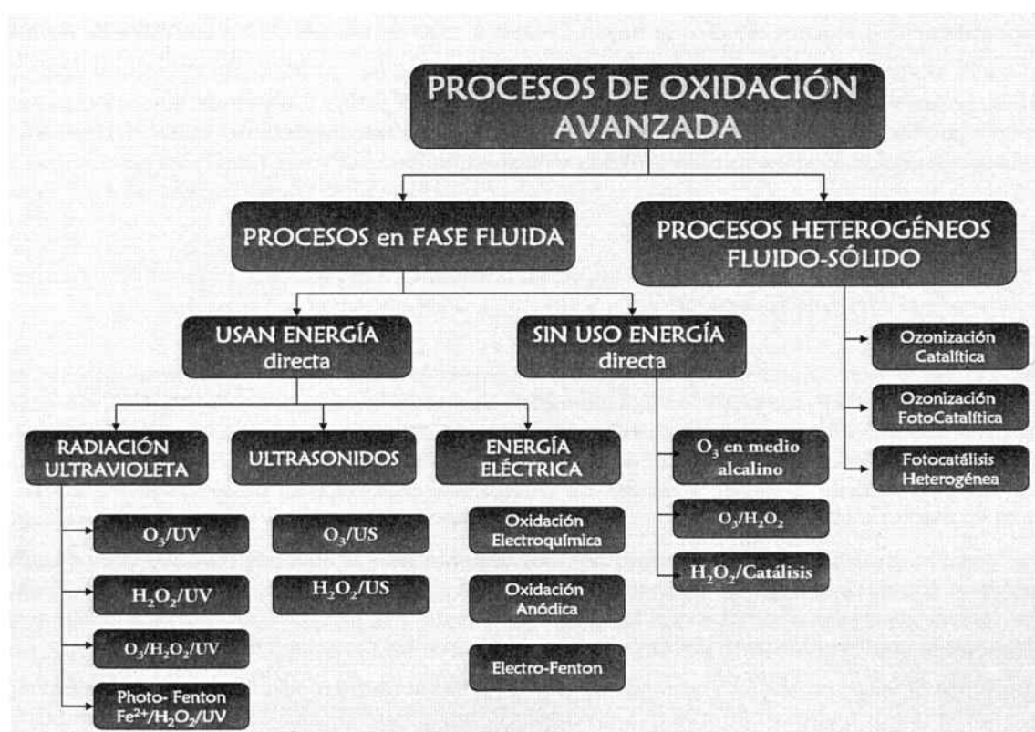
Figura 1.7. Clasificación de Procesos de Oxidación Avanzada [24]. US se refiere a Ultrasonidos.
