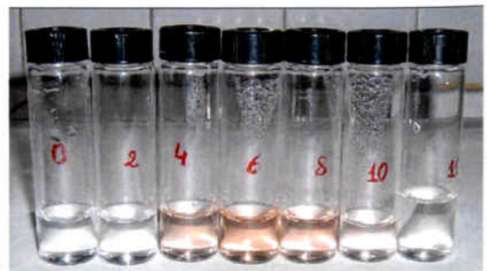
Figura 4.14. muestras tomadas al cabo de las horas indicadas en cada vial. Se observa la diferencia de color. [\text{DCP}]_0 = 125\text{ ppm} , caudal = 27.5 mL/s, pH libre (inicialmente \text{pH}=5.5 ), T=23^\circ\text{C} , c_p = 0,5\text{ g TiO}_2/\text{L} .
