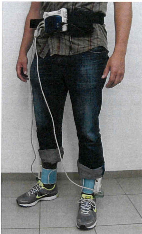
Figura 4.8. Sistema F-Scan un cop tots els components han estat connectats i preparat per fer un registre.
