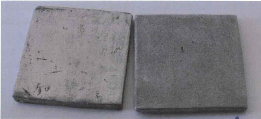
Fig. 3.5 Aspecto de la aleación pre y post arenado
