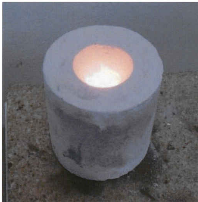
Fig. 3.2 Enfriamiento del colado de la aleación metálica de cromo-cobalto IPS d.SIGN ® 30 de Ivoclar Vivadent ®
