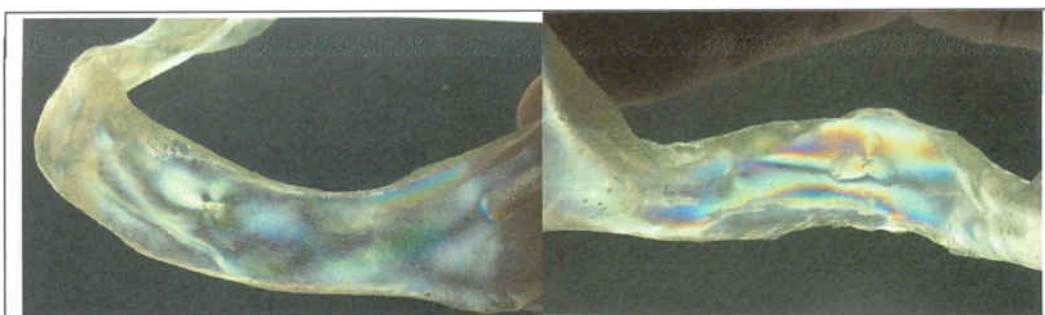
Fig. 17. Zones de tensió en la mandíbula de resina fotoelàstica
