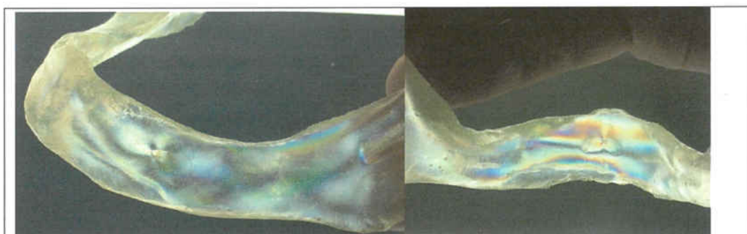
Figura 2. Tensions observades mitjançant fotoelasticitat
