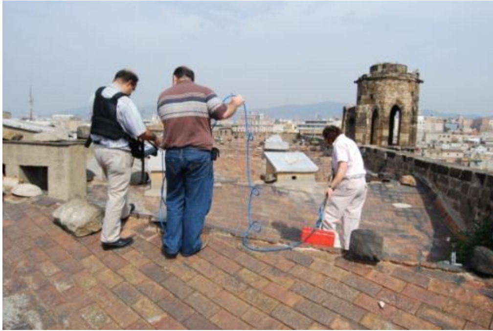
Figura 6. 4: Adquisición de datos con equipo GPR sobre la cubierta de la basílica de Santa María del Pi (Barcelona).
