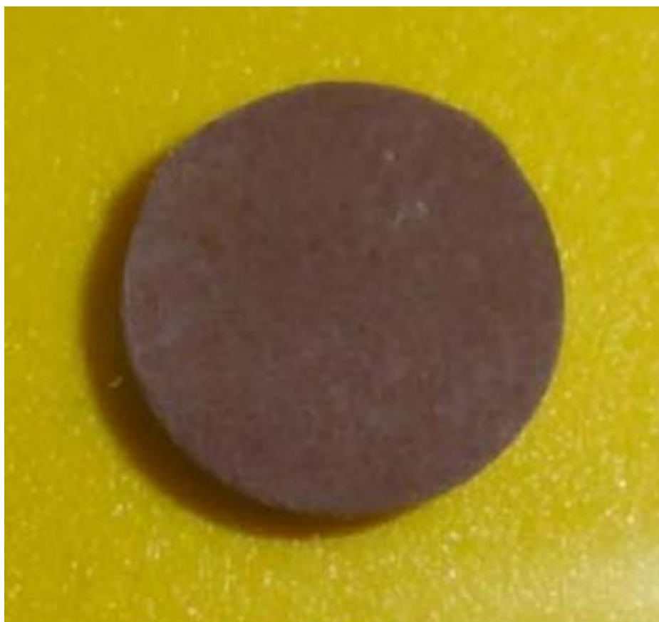
Figura 6. Ejemplo de una pastilla pequeña de \text{SiO}_2@Ag preparada con la ayuda de una prensa hidráulica, el diámetro es de 1.5 cm y el grosor de 1.5 mm.
