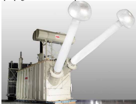
Figura A.1 Transformador de prova de ABB per a rectificador a 800kVdc per a transmissió UHVDC per a la Xina: Xiangjiaba-Shanghai del 2008 (source: https://new.abb.com/ )
