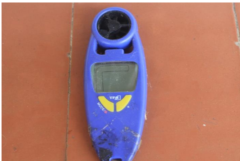
Figura 1.5 Fotografia de l'anemòmetre de mà utilitzat en els transsectes eòlics marca TFA
