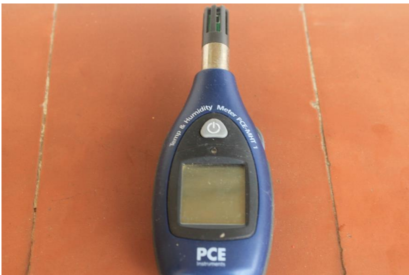
Figura 1.3 Fotografia del Termohigròmetre de mà PCE Ibèrica PCE-MHT1
