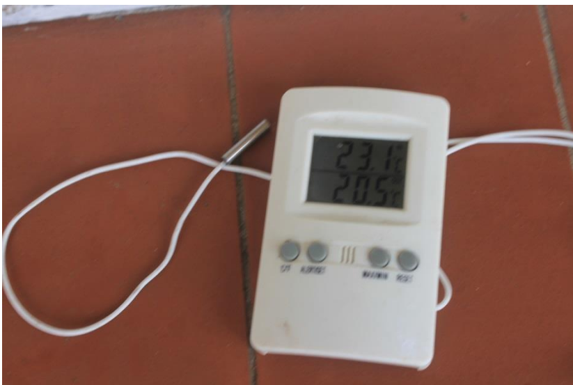
Figura 1.2 Fotografia del Termòmetre amb sonda dels transsectes tèrmics (període 2001-2014) marca TFA-301012
