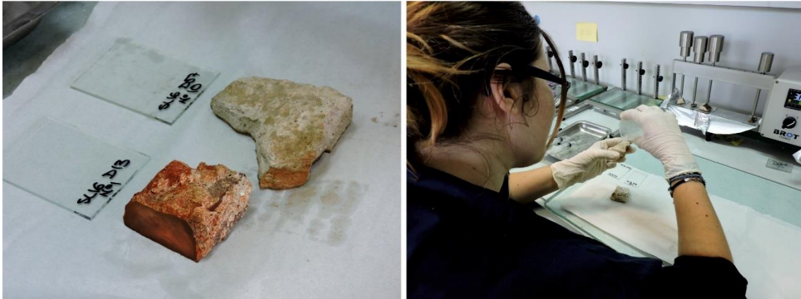
Figura 4.7. Dos muestras de morteros seleccionadas tras el corte de una de sus caras antes de adherirlas al portamuestras (izq.). Aplicación del poliepóxido en una de las muestras (dcha.). Fotografías: Autora (Laboratorio de Gearqueología, IPHES).
