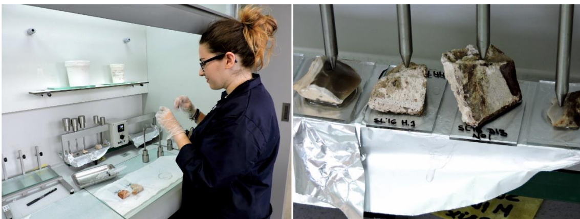
Figura 4.8. Preparación de la prensa calentadora BROT 1.04.02 para colocar el prisma adherido al portamuestras de cristal para su secado (izq.). Detalle de dos muestras durante el proceso de curado (dcha.). Fotografías: Autora (Laboratorio de Gearqueología, IPHES).
