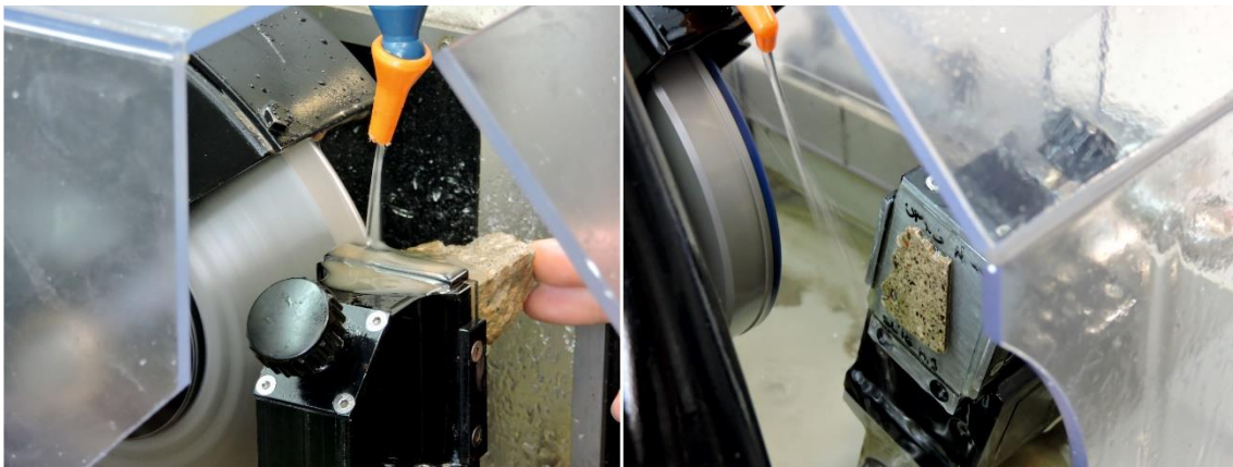
Figura 4.9. Imagen del disco (izq.) y de la desbastadora de diamante (dcha.) durante el proceso de corte y pulido del prisma.
