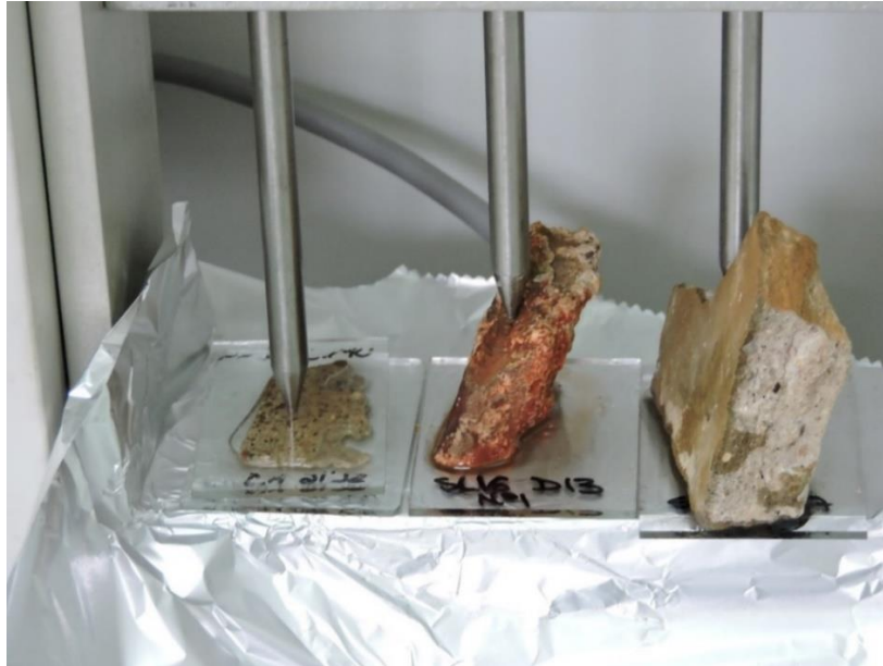
Figura 4.10. Muestra SL'16.H1.UM3.1 (a la izq.) tras la adhesión del portamuestras en la prensa calentadora.
