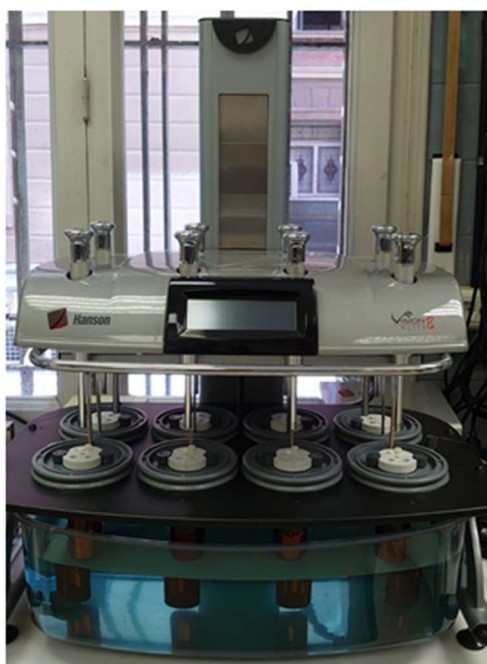
Figura 42. Equip de dissolució Elite 8 TM pels assaigs d'alliberament dels fàrmacs.
