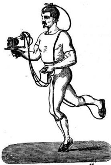
Fig. 72. Coureur muni de chaussures exploratrices et portant l'appareil inscripteur du rythme de son allure.
