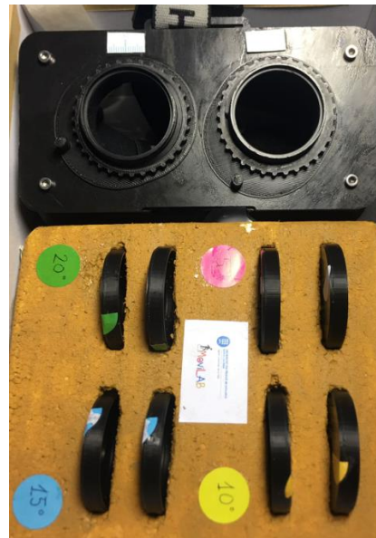
Figura 5. Caja de las gafas de simulación de MoviLab. En la parte superior se observa la montura y en la inferior los 4 pares de capuchones que representan las diversas limitaciones de CV.
