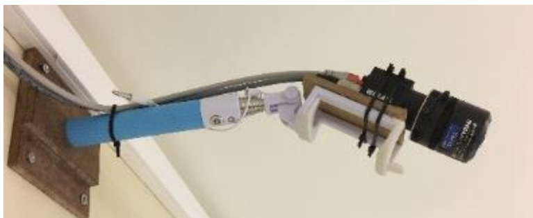
Figura 7. Cámara de vídeo Gran Angular Full HD (MEGAPIX C 1.8-3mm).
