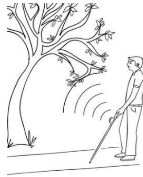
Figura 3. Simulación del efecto de un sensor ultrasónico situado en un bastón (SmartCane 2016).
