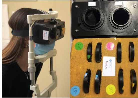
Figura 1. Colocación del observador con las gafas y mentonera (izq.). Gafa de simulación y los capuchones que simulan diversas condiciones (dcha.)
