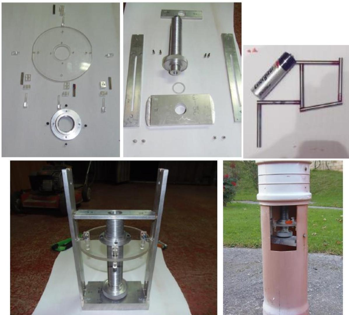
Figura 57. Despiece del plato de compensación del dispositivo del profesor Arribalzaga. Fuente: Arribalzaga, 2016, p. 96. (arriba izda.)
