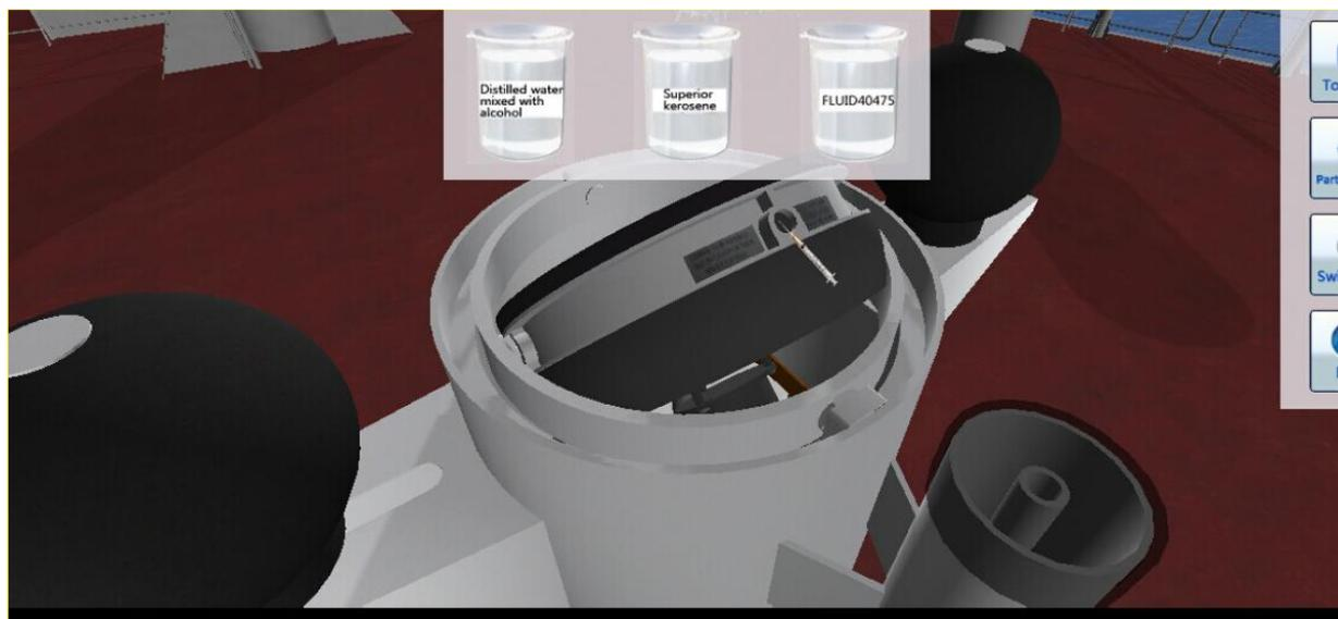
Figura 70. Compás magnético virtual en 3D: operación de eliminar la burbuja, rellenando el mortero con el líquido adecuado. Fuente: *2015 International Conference on Virtual Reality and Visualization*, p. 315.
