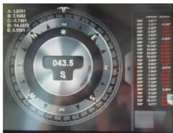
Figura 55. CMI indicando el rumbo satelital; la tablilla de los desvíos, y los coeficientes A,...,E. Fuente: Arribalzaga, 2016, p. 134. (dcha.)
