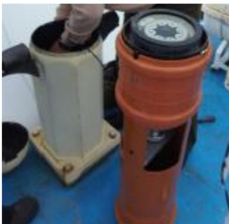
Figura 62. Mortero instalado en la bitácora con el dispositivo del profesor Arribalzaga. Fuente: Arribalzaga, 2016, p. 113.
