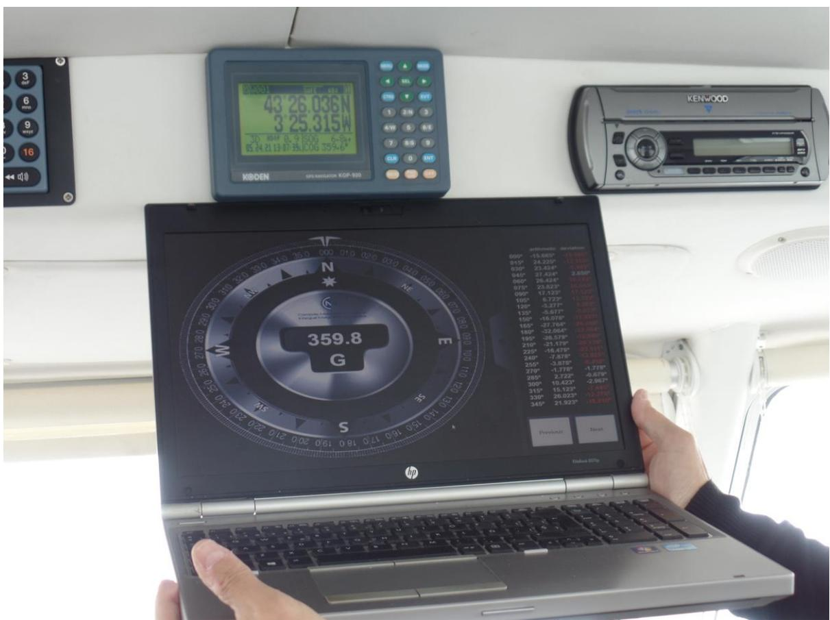
Figura 84. Lectura de los rumbos efectivos, comparando el rumbo verdadero indicado por el CMI y el COG dado por el GPS: detalle de la lectura del COG al rumbo verdadero N. Fuente:Propia.
