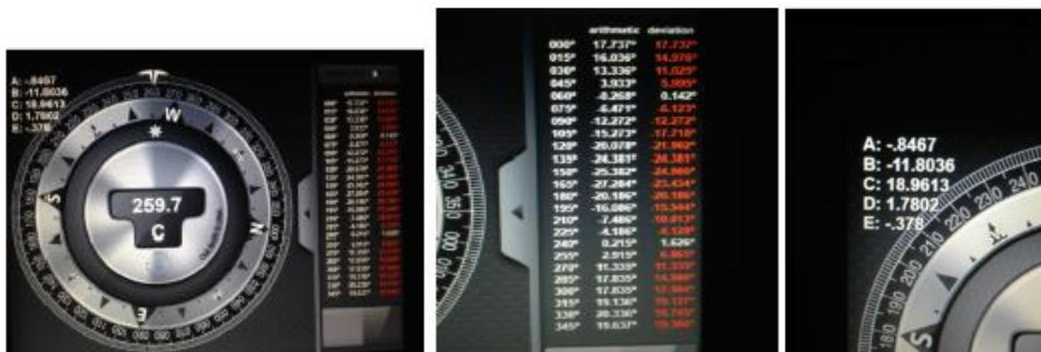
Figura 98. Fotografía del CMI instalado a bordo del buque ORTZE, en el que figuran los desvíos obtenidos y los coeficientes A,...E. Fuente: Arribalzaga, 2016, p. 116. (izda.)
