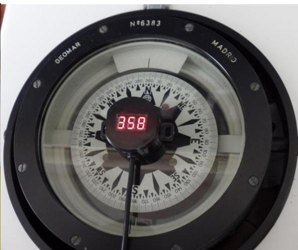
Figura 74. Compás magnético del buque ATO en el momento de ajustar el sensor del CMI. Fuente: Propia. (izda.)
