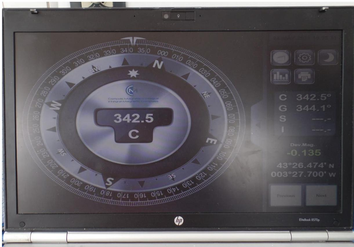
Figura 76. CMI (en modo *Compass*) con las indicaciones de: rumbo de aguja (C); rumbo verdadero (G), tomado del compás satelital; situación, y declinación magnética. Fuente: Propia.
