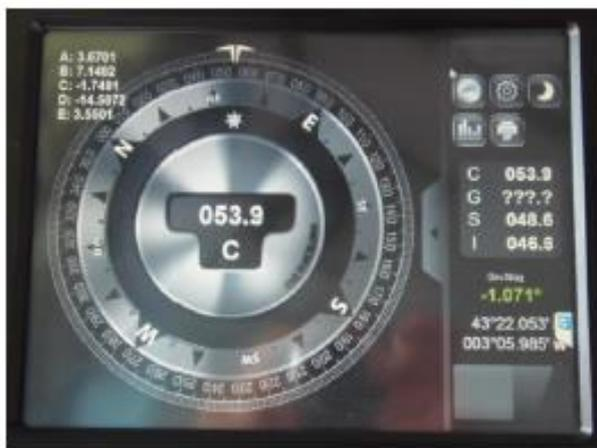
Figura 54. CMI indicando el rumbo de aguja; el menú con las opciones de rumbo, y los coeficientes A,...,E. Fuente: Arribalzaga, 2016, p. 133. (izda.)
