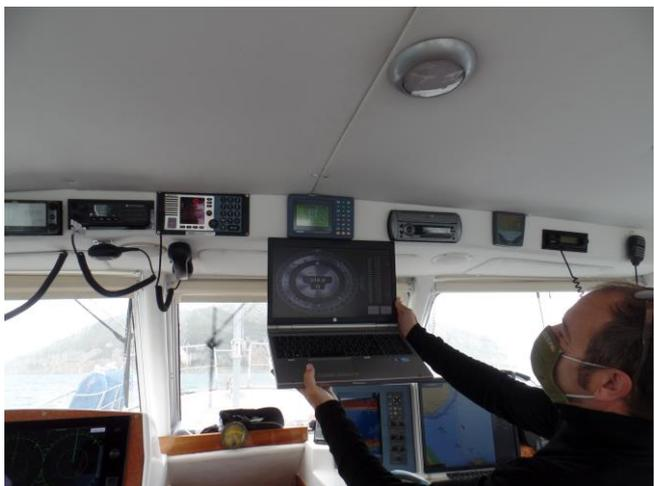
Figura 83. Lectura de los rumbos efectivos, comparando el rumbo verdadero indicado por el CMI y el COG dado por el GPS. Fuente:Propia.
