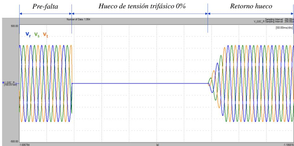
Figura 6.8 Registros de tensiones de red para hueco trifásico severo en vacío
