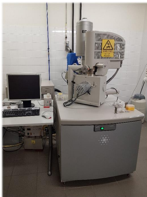
Figura 38. Equipo de microscopia electrónica de barrido FEG ESEM Quanta 200F.
