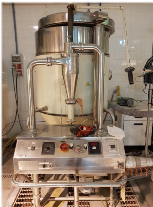
Figura 44. Equipo de secado por atomización Mobile Minor.
