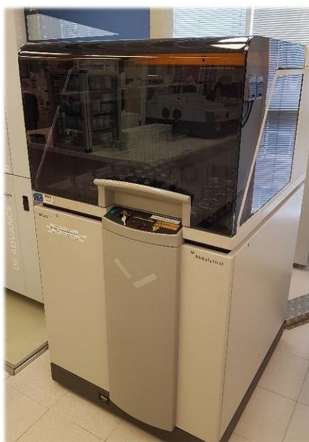
Figura 53. Espectrómetro de fluorescencia de rayos X, AXIOS.
