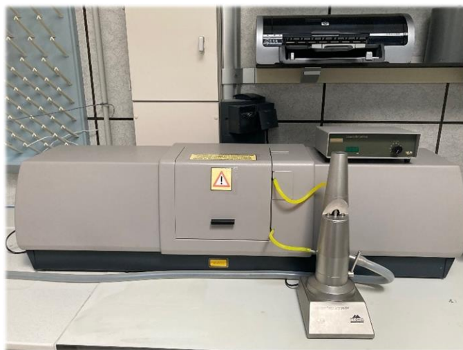
Figura 37. Difractómetro láser Mastersizer S (Malvern, Reino Unido).
