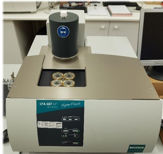
Figura 55. Equipo de destello por lámpara de xenón para la determinación de la conductividad térmica, LFA 467 HT Hyperflash.
