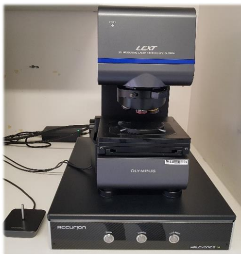
Figura 51. Equipo de análisis topográfico de escaneo láser LEXT OLS5100.
