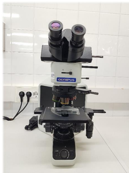
Figura 50. Equipo de microscopía óptica, Olympus BX53M.
