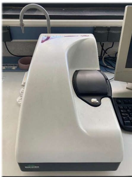
Figura 40. Equipo de dispersión dinámica de luz empleado para la determinación del potencial zeta (Nanosizer NanoZSD).
