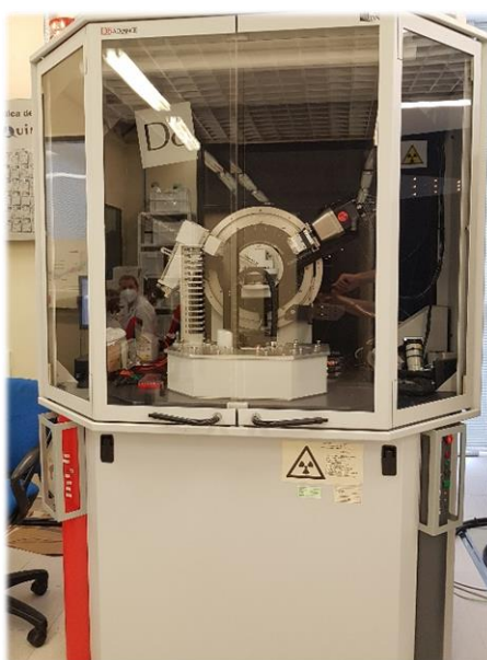
Figura 52. Equipo de difracción de rayos X Bruker Theta-Theta modelo D8 Advance.
