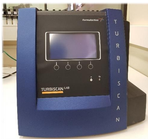
Figura 43. Equipo de determinación de la sedimentación, TurbiScan LabExpert.
