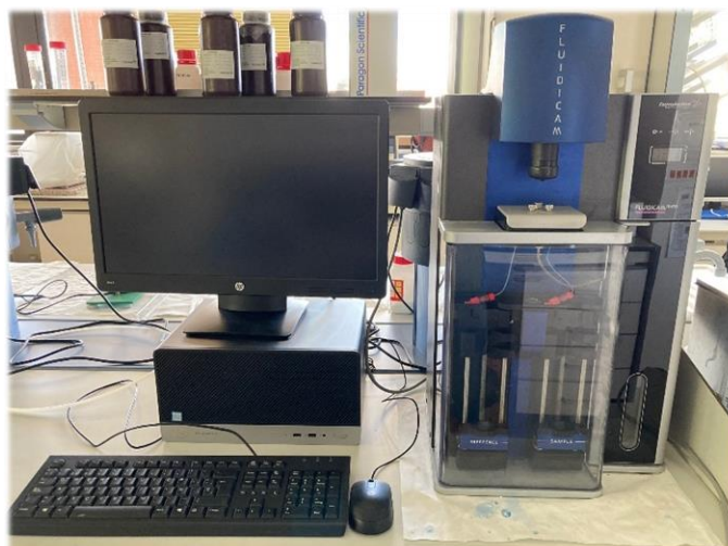
Figura 42. Reómetro óptico de microfluidos por tecnología chip, Fluidicam Rheo.
