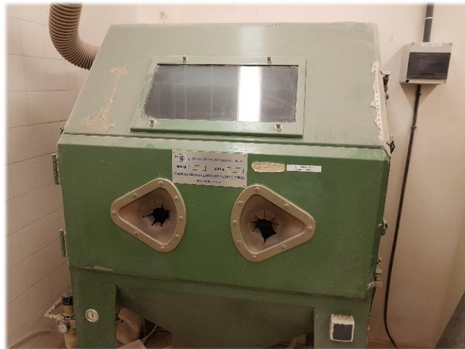
Figura 46. Cabina granalladora, modelo MAB-6.
