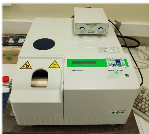
Figura 54. Equipo de análisis ATD-TG SDTA-e de Mettler Toledo
