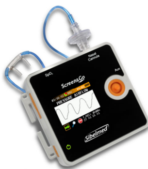
Figura 4 – Polígrafo cardiorrespiratorio que se empleó para el estudio de monitorización ambulatoria (EMA)
