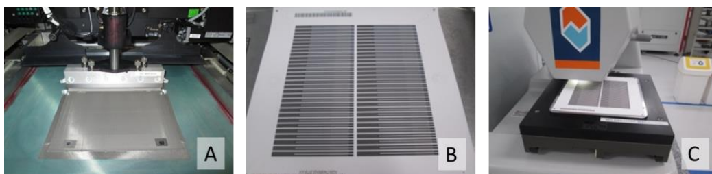
Figura 2. 28. Imatges del procés de serigrafia A: procés d'impressió. B. Substrat serigrafiat. C. Caracterització del gruix.
