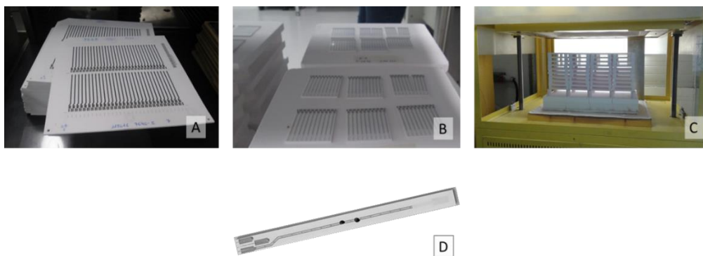
Figura 2. 35. Imatges del procés de sinterització. A. Substrats sense sinteritzar. B. Substrats pre-tallats. C. Disposició dels substrats a l'interior del forn. D. Sensor ceràmic sinteritzat
