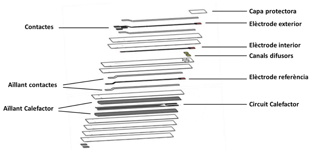
Figura 2.3. Estructura de capes dels sensors amperomètrics fabricats. L'estructura mostrada es correspon amb els sensors mostrats a la Figura 2. 2
