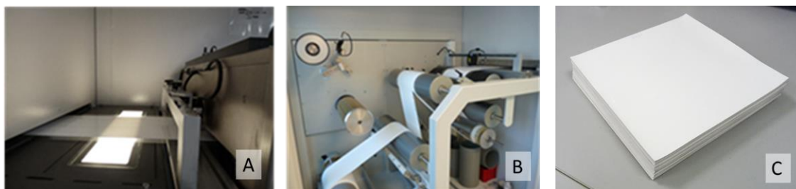
Figura 2. 21. Imatges del procés d'obtenció del substrat ceràmic. A. Dosificació de la suspensió. B. Bobinat. C. Substrats tallats preparats per la serigrafia.
