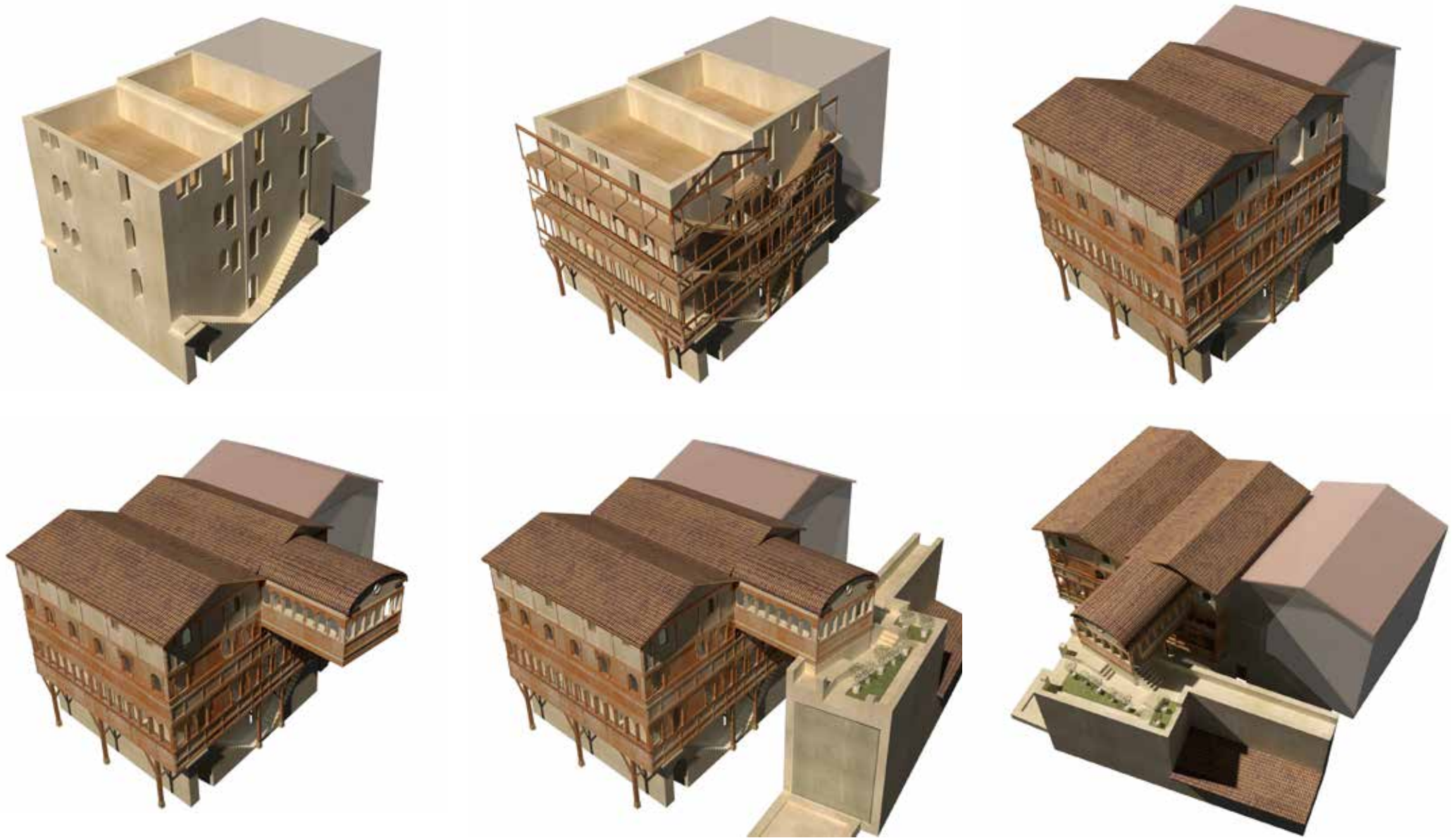
fig.111 a 118 Hipotética reconstrucción por el autor de las casas torres de Verastegui y Babaça así como de su estructura constructiva.
