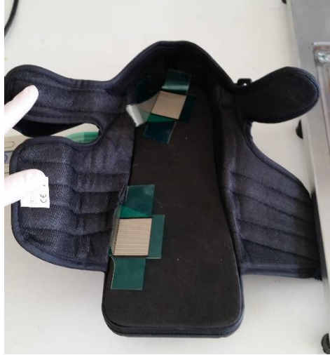
Figura 54: col·locació dels sensors dins de la sabata ortopèdica. Autor: Font pròpia.
