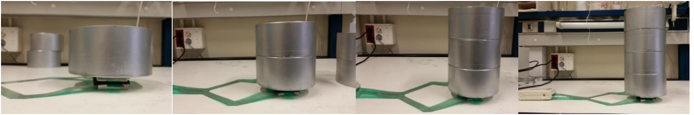
Figura 52: col·locació progressiva de les peses de 10 kg en el procés de calibratge. Autor: Font pròpia.
