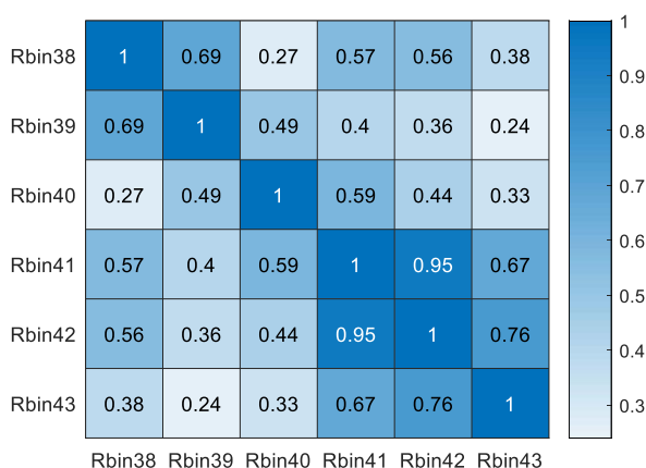
Figura 7-14. Matriz de correlación lineal entre las señales de los Rbins seleccionados. Color azul oscuro indica una mayor correlación.
