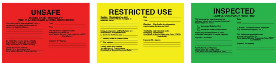
Figura 2-3. Etiquetas de evaluación post-sísmica para edificios revisados según el ATC-20 Rojahn (2005).
