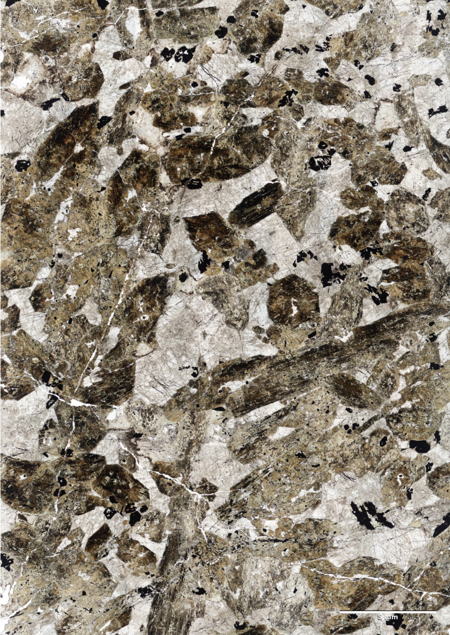
Figura 7.14: Bojita de gra gros S16-60. Els minerals dominants són l'hornblenda i la plagiòclasi. El mineral opac és ilmenita. LPP.
