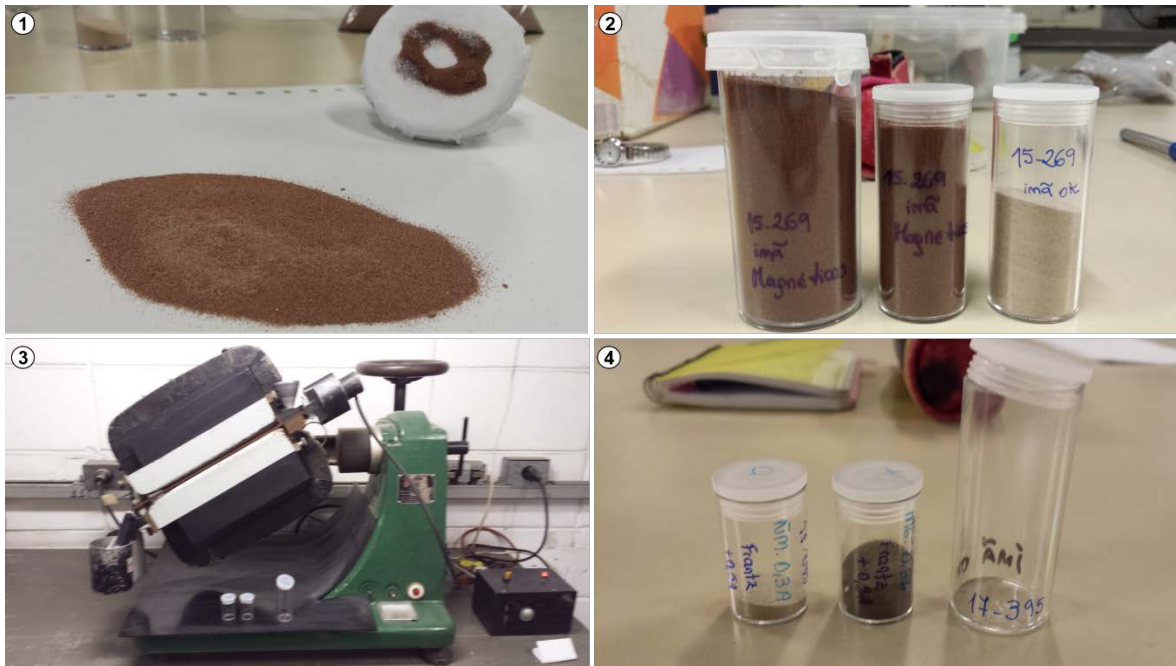
Fig. 9.15: Separación de fases magnéticas con imán de mano y por Frantz. Nótese la proporción de minerales magnéticos en la etapa 1 y 2 en relación con la fase no magnética (misma muestra, tubo de color más claro). En 3 y 4 lo que se procesa en Frantz es el resultado de la fase clara del paso 2. Nuevamente la proporción de minerales máficos magnéticos es elevada respecto de las fracciones no magnéticas. La muestra 15-269 corresponde a NUR y la 17-395 a TRQA.
