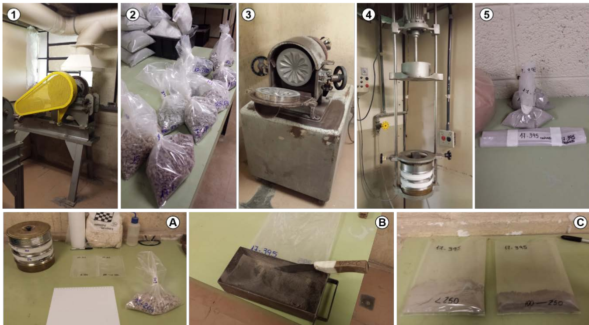
Fig. 9.13: Trituración, pulverización y tamizado de muestras. De 1 a 5 procesos repetitivos sistemáticos hasta alcanzar la granulometría óptima <200 \mu m. De A C se observa la reducción granulométrica hasta las porciones deseadas.
