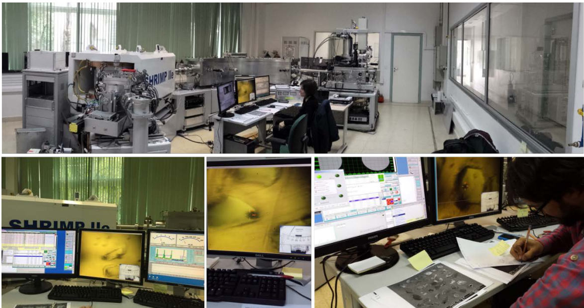
Fig. 9.20: Medición de cristales de zircon con equipo SHRIMP-IIe/MC. Centro de Pesquisas Geocronológicas, Laboratório de Geocronologia de Alta Resolução-Geolab (USP). São Paulo, Brasil.
