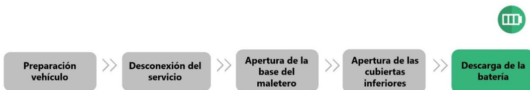
Figura 25. Proceso de extracción y desmontaje de la batería
