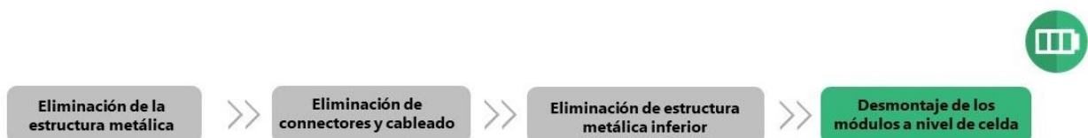
Figura 30: Proceso de desmontaje de los módulos a nivel de celdas
