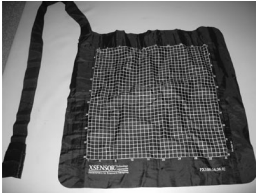
Figura 1.8. Sistema mapeig de pressió Xsensor® utilitzat en l'estudi de Trewartha i Stiller. Trewartha i Stiller, 2011.
