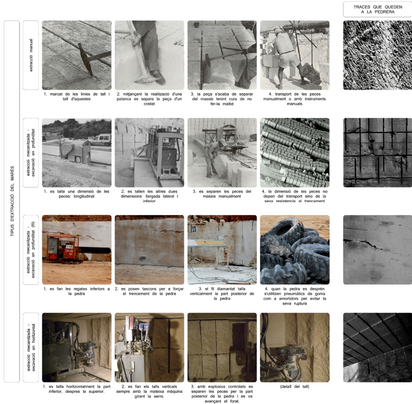
Fig. 119 Estudi dels diferents sistemes extractius pel marès i de les traces que generen a la pedrera. Imatges 1, 2, 3 i 4 de la fila 1 i 3 de la fila 2 extretes de (Florit i Sauleau, 1995: 40-41), resta d'imatges realitzades per l'autora.
