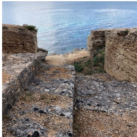
Fig. 147 Pedrera d'extracció manual situada a la costa. Pedrera de Son Verí a Lluçmajor. Fotografia de l'autora. 2018
