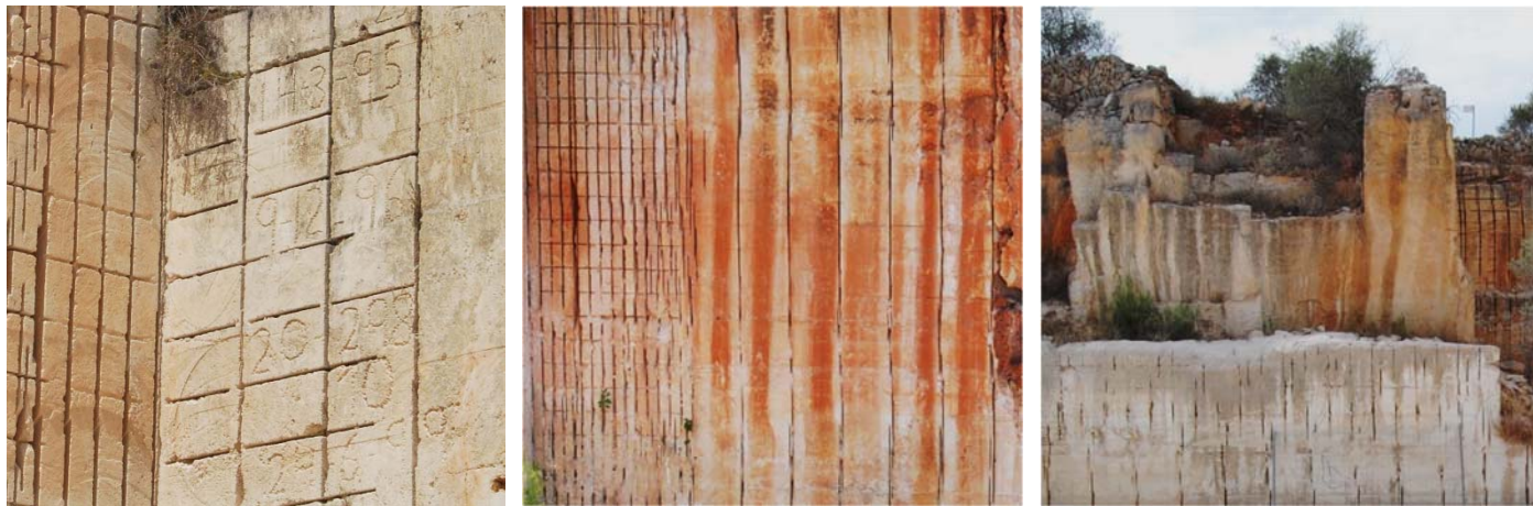
Fig. 120 Detall de la pedrera de Vernissa Vell (SM01), a Santa Margalida, on es marquen les dates en que es va avançant en profunditat a la pedrera. Fotografia pròpia, 2011.
