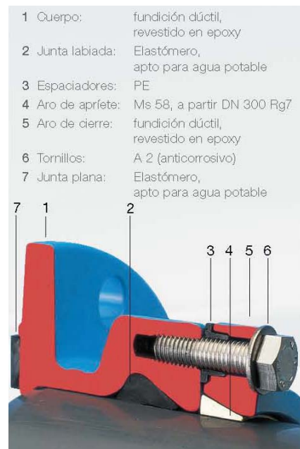
Fig. 112. Brida auto-blocadora. System 2000. Hawle.
