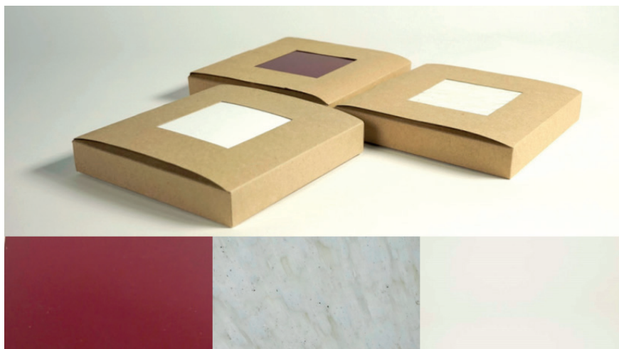
Figura 4.8. Muestras de material. En orden de izquierda a derecha: M1, materia prima con el nombre comercial Altuglas; M2, material reciclado de Carpintería Plástica; y M3, material reciclado que no lo parece llamado Syntal.
