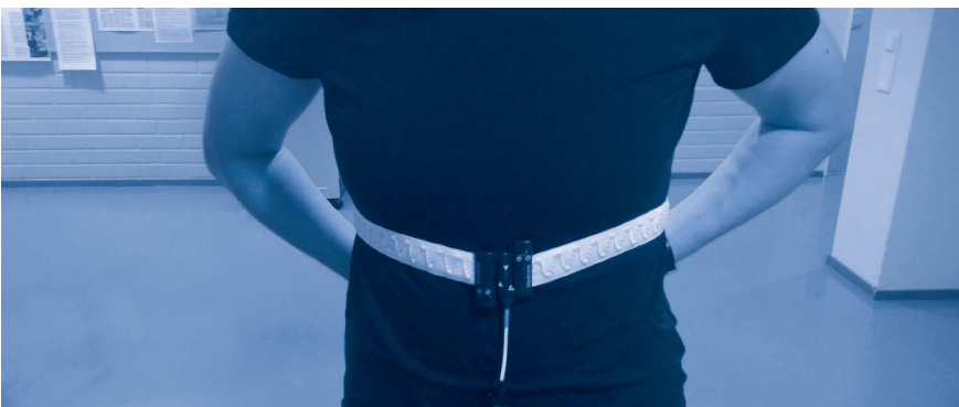
Figura 4.3. Prueba para medir la respiración, mediante el método de pletismografía de inductancia respiratoria (PIR).
