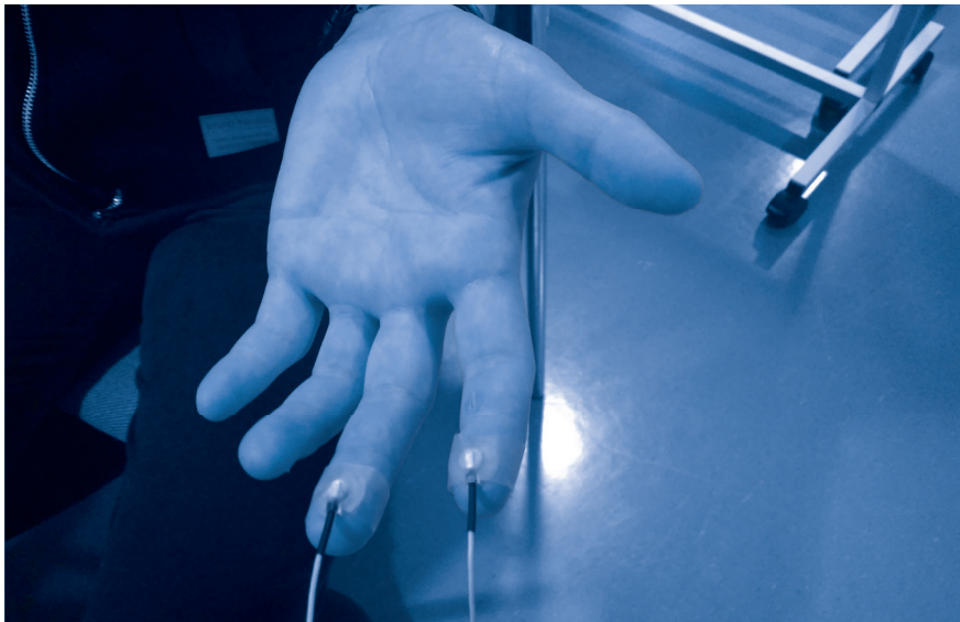
Figura 4.1. Prueba de la actividad electrodérmica (EDA) con electrodos.
