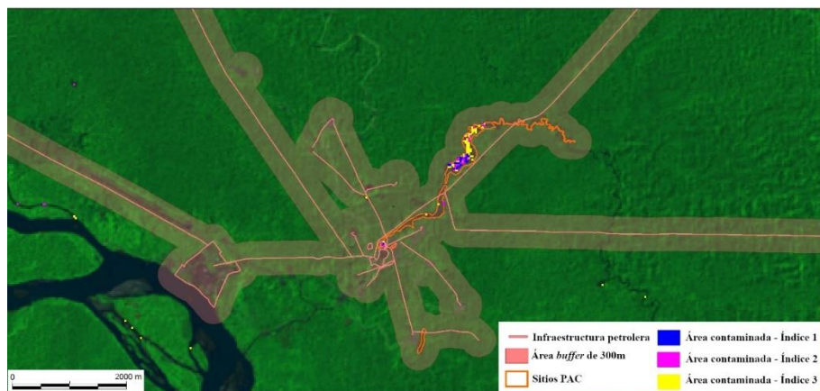
Figura 4.6. Áreas contaminadas por hidrocarburos detectadas por los índices 1, 2 y 3 en el centro de producción de Capahuari Sur para la imagen del 23 de noviembre de 1993.
