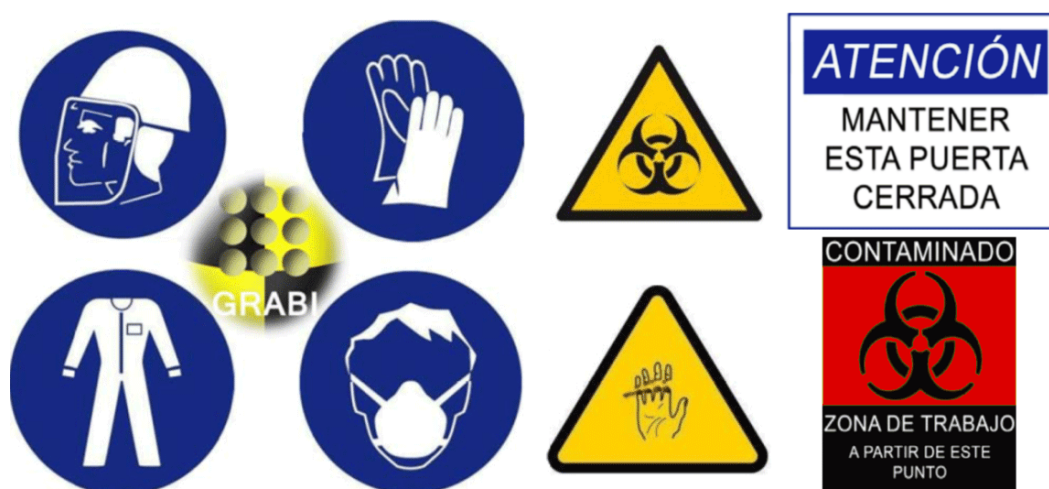
Figura C.1. Señalización de los equipos de seguridad obligatoria, riesgos en la zona de trabajo y delimitación de las zonas.
