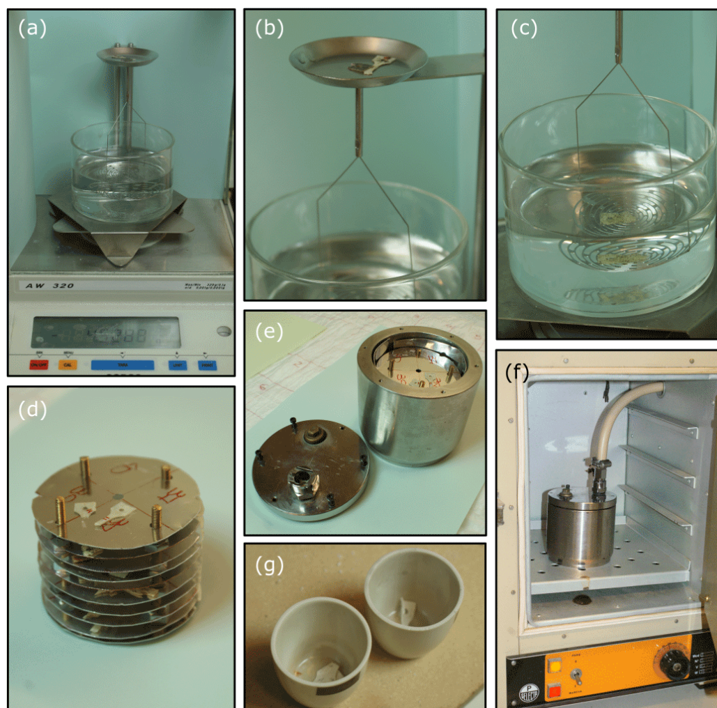
Figura 3.14. Proceso de secado y calcinación de coupons : (a) Balanza hidrostática para determinar la densidad y masa de los coupons , (b) pesaje en seco en la bandeja superior de la balanza, (c) pesaje de la muestra sumergida en suero, (d) colocación de los coupons en el sistema de separación, (e) introducción del sistema de separación con los coupons en el vaso de vacío, (f) secado de las muestras en la estufa en condiciones de vacío, (g) introducción de los coupons en los crisoles para la calcinación.
